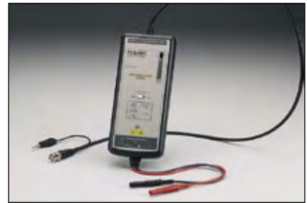
TT-SI 9110 Дифференциальные пробники TESTEC ELEKTRONIK GmbH
