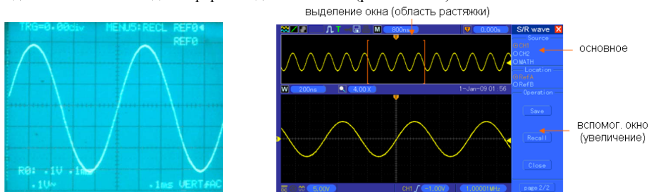
Рис.3 Отображение синусоидального сигнала
