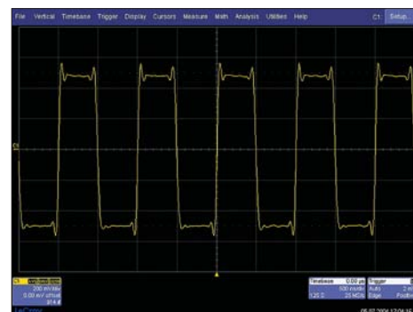
Рис. 7. Интерполяция sin x/x, частота дискретизации — 25 МГц, входной сигнал — меандр с частотой 1 МГц
