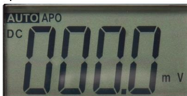
Рис. 6.4. индикация ЖК-дисплея АКИП-2204
