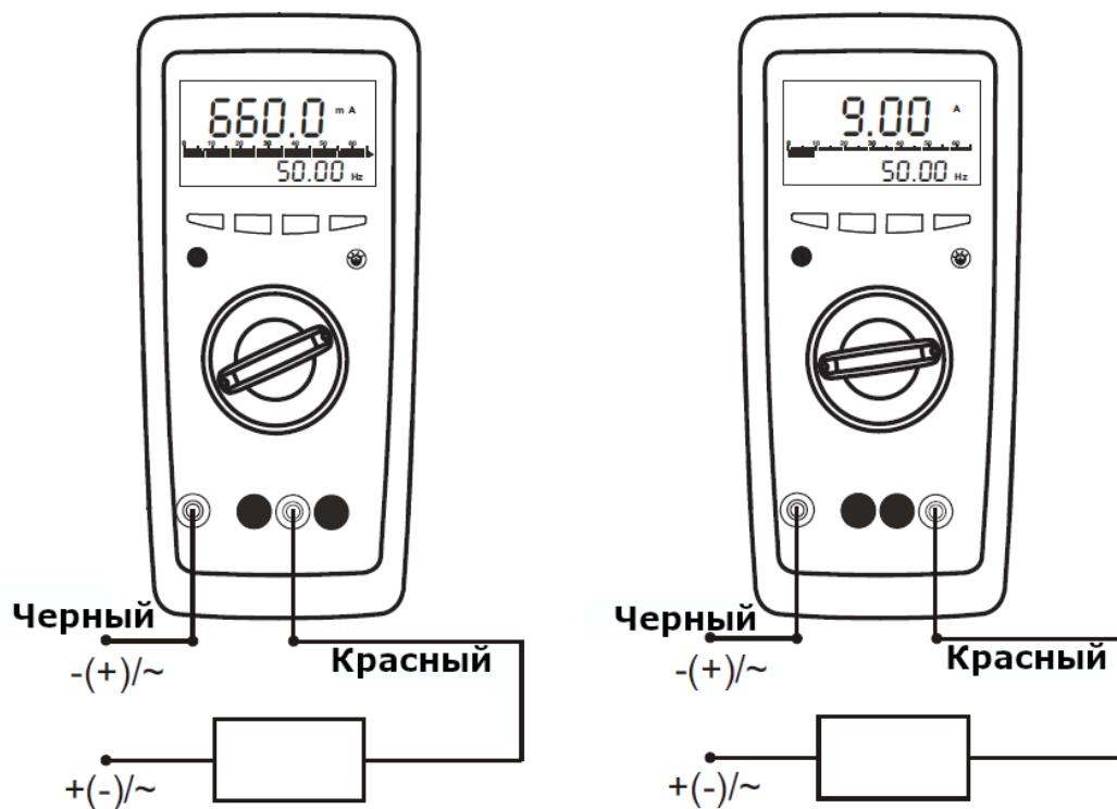
Рис. 6.2 Схема подключения при измерении силы тока
