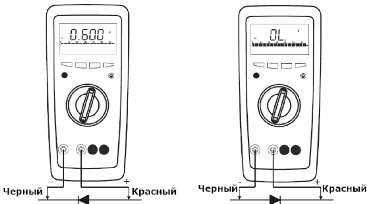
Рис. 6.6 Схема подключения в режиме испытания р-п переходов
