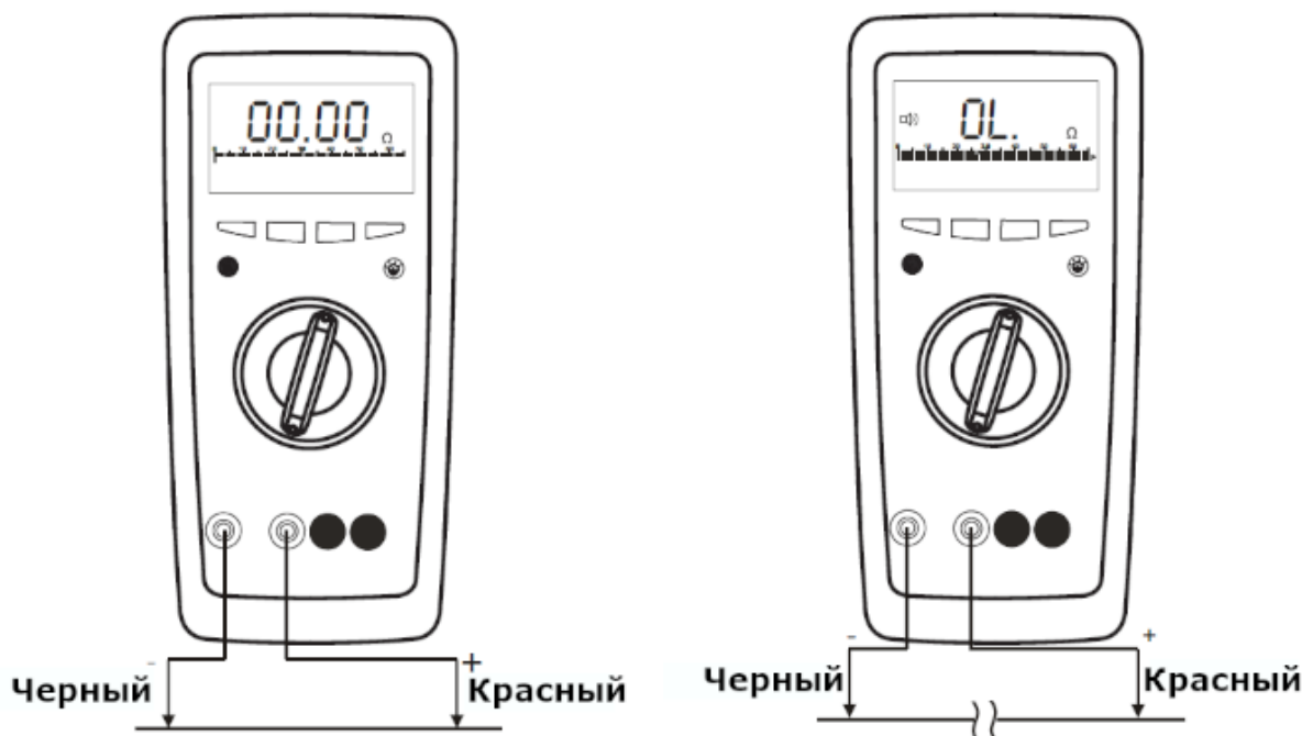
Рис. 6.5 Схема подключения для звуковой прозвонки цепи
