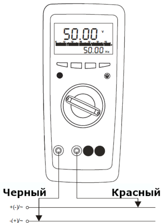
Рис. 6.1 Схема подключения при измерении напряжения
