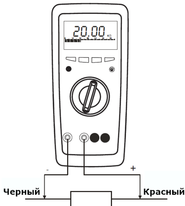
Рис. 6.4 Схема подключения при измерении сопротивления
