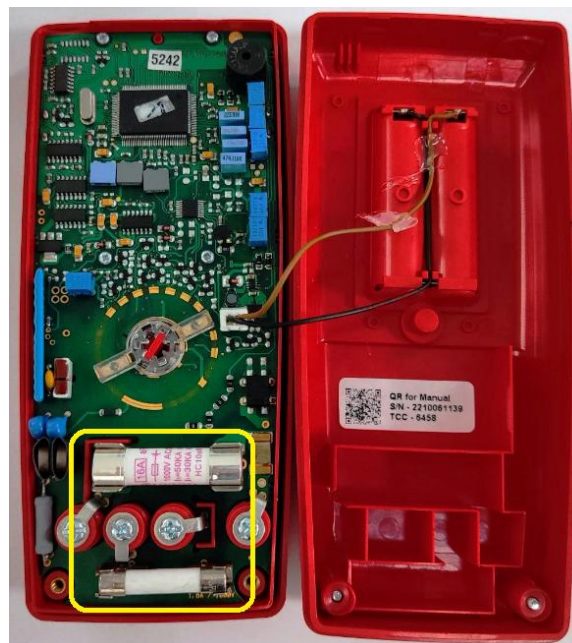
Рис. 7.3 Прибор со снятой задней панелью (на фото внизу в рамке - 2 предохранителя )
