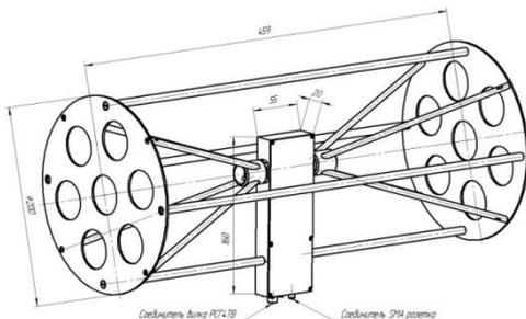
**Рис. 1** Габаритный чертеж антенны П6-220
