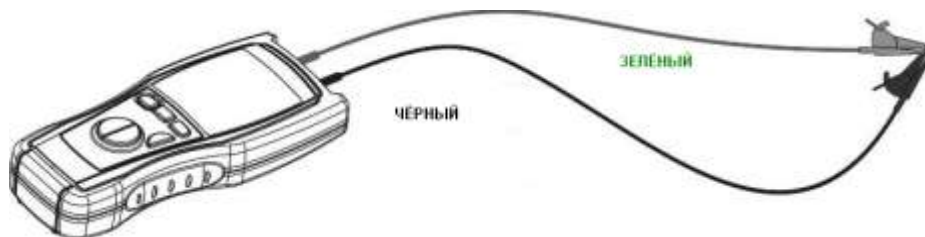
Рис.5: Схема подключения измерительных проводов прибора для калибровки
