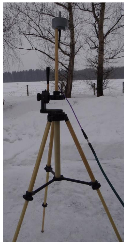
Фото2. Антенна АС7.23 на диэлектрическом штативе
