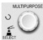
Многофункциональный регулятор с нажатием на кнопку **MULTIPURPOSE** предназначен для выбора заданного значения. Поверните ручку, чтобы выбрать параметр или всплывающее подменю, затем нажмите ручку, чтобы подтвердить выбор.
