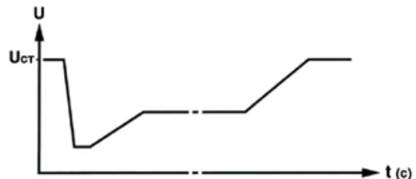
Стартовый профиль с импульсом провала напряжения при запуске ТС / Start pulse
