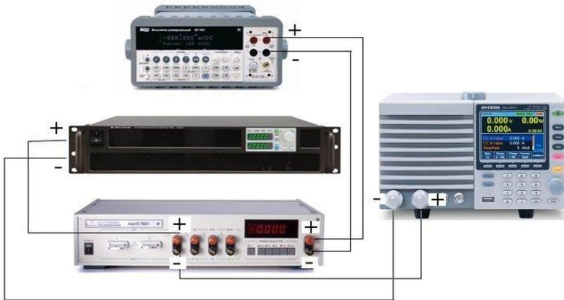
Рисунок 2 Структурная схема соединения приборов для определения абсолютной погрешности установки постоянного тока и измерения силы постоянного тока для PEL-7300
