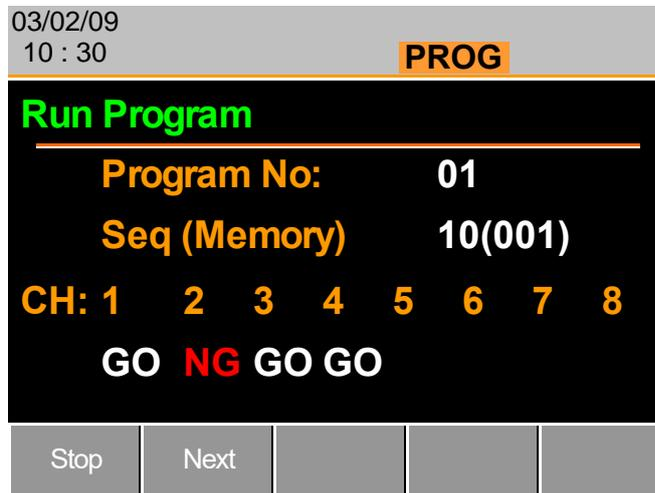
По завершении каждой последовательности или программы экран будет обновляться и отображать действующую последовательность/программу. Если в настройках канала установлены пределы Go/NoGo (Годен/Не годен), результаты испытания (GO/NG) будут отражаться на основном дисплее, а также на дисплее локального нагрузочного модуля. Иконка программы станет оранжевой при запуске программы.
