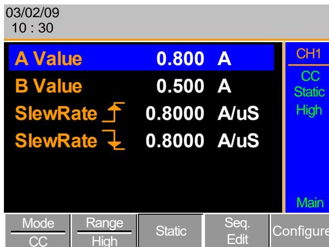
Нажмите поворотный регулятор для редактирования выбранного значения, затем поворачивайте регулятор для увеличения или уменьшения значения. ИЛИ Для ввода значения используйте цифровую клавиатуру.
