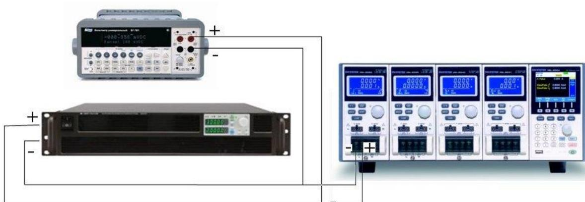
Рисунок 3 Структурная схема соединения приборов для определения абсолютной погрешности установки и измерения напряжения постоянного тока для PEL-72000
