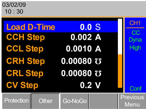
2. Используйте поворотный регулятор для выделения пункта Load D-Time.
