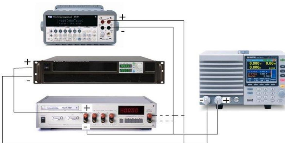
Рисунок 7 Структурная схема соединения приборов для определения абсолютной погрешности установки сопротивления для PEL-73000
