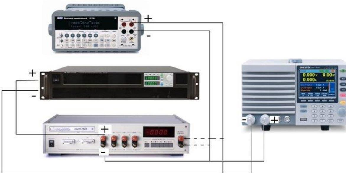
Рисунок 5 Структурная схема соединения приборов для определения абсолютной погрешности установки мощности для PEL-73000
