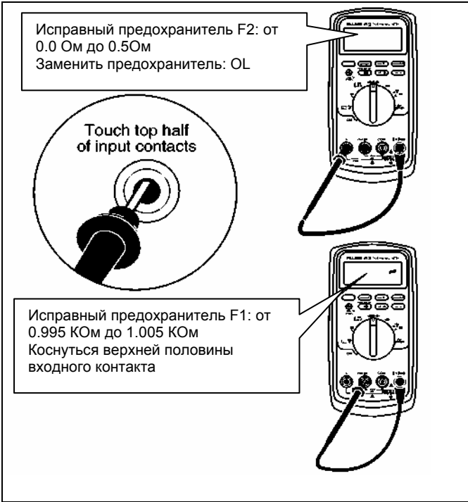
Рисунок 10. Контроль предохранителей тока
