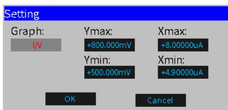
Имеется 4 вида графиков: зависимость силы тока от напряжения I/V, напряжения от силы тока V/I, напряжения от времени V/t, силы тока от времени I/t. Значения Xmax, Xmin, Ymax, Ymin являются максимальными и минимальными координатами по осям X и Y (Замечание: рекомендуется настраивать координаты для отображения графиков во весь экран).
