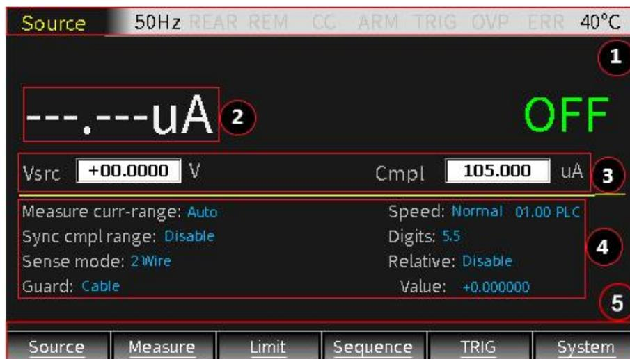
Дисплей используется, в первую очередь, для программирования источника и установки уровня ограничения сигнала на выходе прибора, а также отображения реальных результатов измерений. Дисплей прибора включает следующие зоны.
