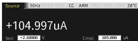
Точность прибора в режиме измерения выше, чем в режиме воспроизведения. Поэтому для обеспечения оптимальной точности рекомендуется выбирать одинаковые функции измерения и воспроизведения и использовать измеренные значения вместо запрограммированных.
