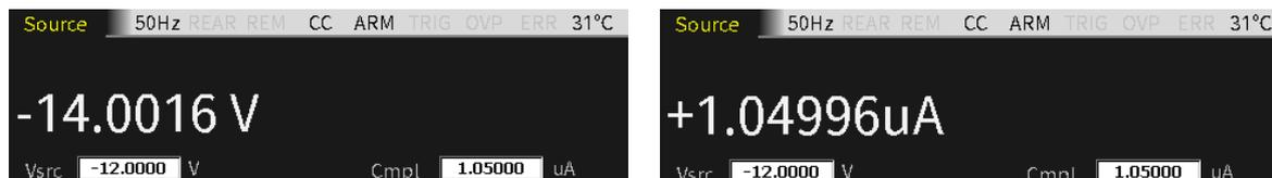
Если подключить прибор к источнику питания –14 В (разъём Input/Output HI подключается к положительному контакту батареи), установить его в режим источника напряжения –12 В и настроить уровень ограничения сигнала на выходе (Cmpl) так, чтобы прибор работал в режиме стабилизации напряжения (CV), тогда GSM7-20H10 будет функционировать во четвёртом (IV) квадранте.
