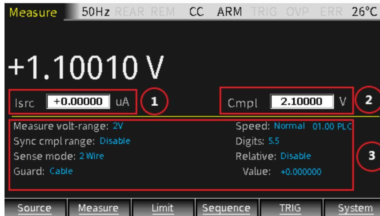
Для измерения силы тока 1,05 мА настроить прибор для работы в качестве источника напряжения. Установить предел измерения 10 мА, Isrc на 000,000 мВ, пороговое значение Cmpl на 10,5 мА. Нажать клавишу включения выхода «Output» для отображения результата измерений.
