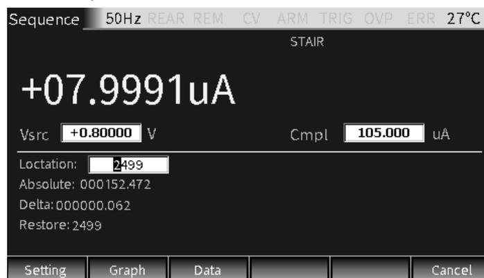
2. Нажать клавишу F2 (Graph) для просмотра результатов измерений в графическом виде.
