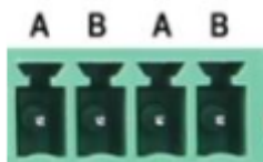
Рис.6.22 Схема интерфейса RS485
