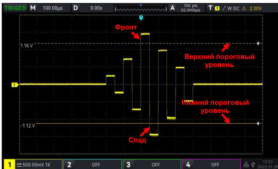
Рис. 13-7 Схема синхронизации по превышению уровня импульса
