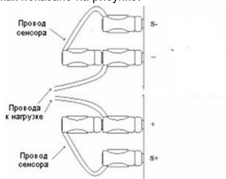
Рис. 7.1 Схема подключения удаленной нагрузки
