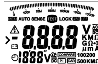
Рис. 6.2. Переключатель режимов (слева), символы индикации ЖК-дисплея (справа)
