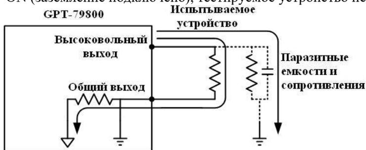
3. GROUND MODE = OFF (заземление отключено), тестируемое устройство не заземлено:
