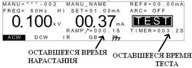
Ниже представлены примеры отображения экрана в различных режимах испытаний:
