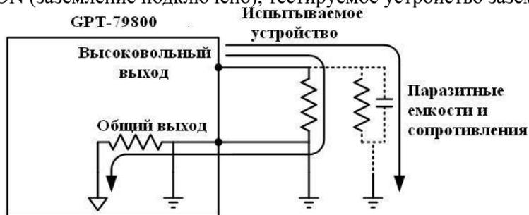
2. GROUND MODE = ON (заземление подключено), тестируемое устройство не заземлено:
