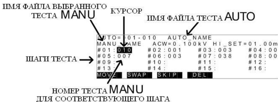
В режиме просмотра страницы автоматического теста активны функции удаления, пропуска, перемещения и замены шагов из которых состоит тест.
