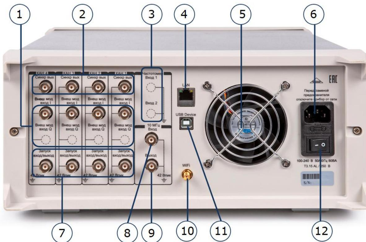
1. Входы сигнала модуляции
