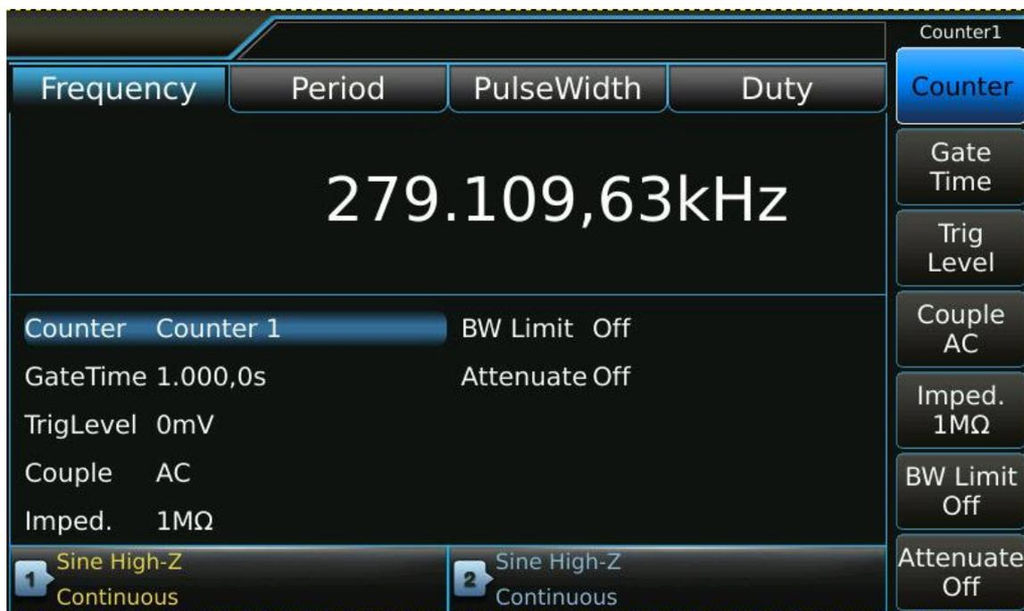
Для канала 1 (Counter 1) имеется возможность установки таких параметров как: время счета, уровень запуска, связь входа, ограничение частоты и аттенюатор.
