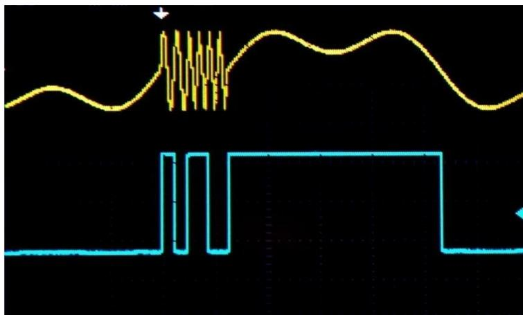
Форма - формирование одного синхроимпульса для каждой формы сигнала в заданной последовательности сигналов, как это показано на рисунке ниже.
