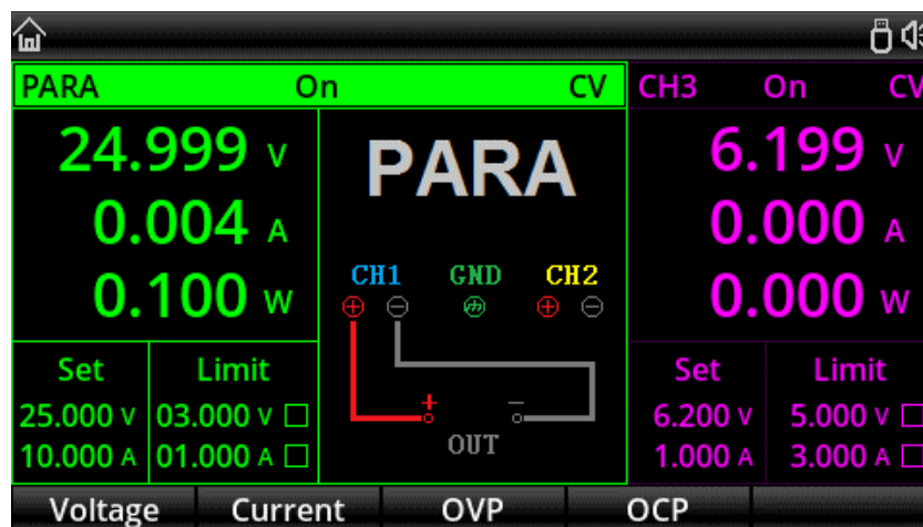
Рис.7.6 Пример интерфейса прибора в режиме параллельного объединения каналов
