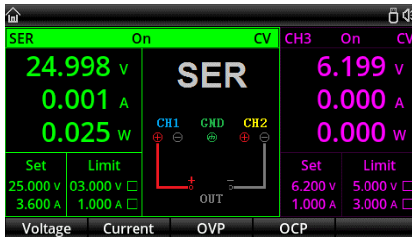
Рис.7.4 Пример интерфейса прибора в режиме последовательного объединения каналов
