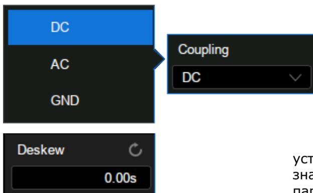
**Список:** установка параметров с более чем двумя параметрами, такими как связь входа. Коснитесь области параметров и выберите ожидаемый вариант во всплывающем списке.
