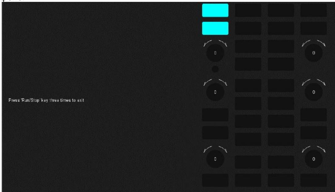
**Тест регуляторов:** Поверните каждую ручку по часовой стрелке, против часовой стрелки и нажмите. Посмотрите, увеличивается или уменьшается значение на соответствующей ручке (по умолчанию 0) на экране в реальном времени, и загорается ли ручка при нажатии.
