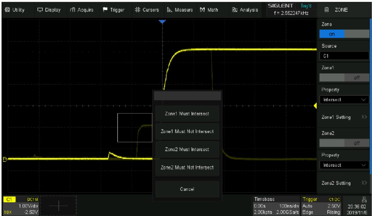
**Рис. 17-4 Пример выделения области синхронизации**
