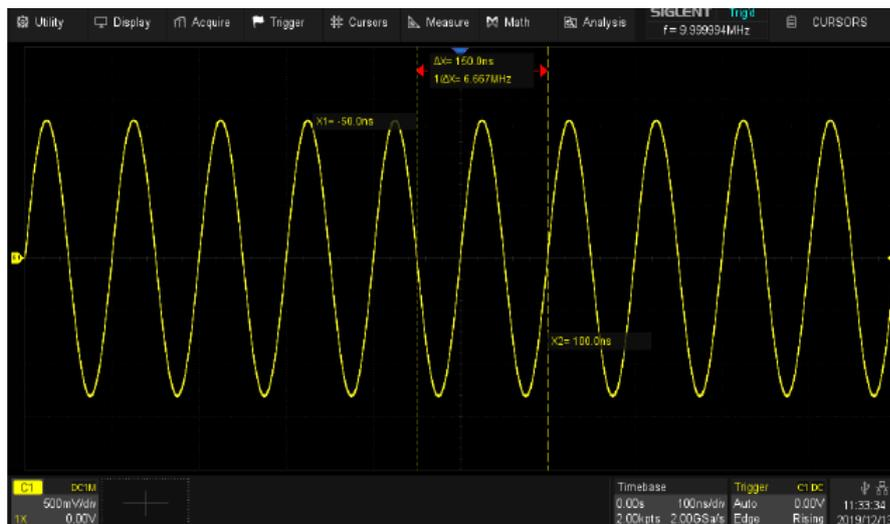
В качестве опорной точки выбрано фиксированной временное значение. Коэффициент развертки установлен на 100 нс/дел. Положение курсоров остается фиксированным во временной области, X -50 нс и 100 нс. При этом изменяет положение на сетке экрана, X -0,5 деления и 1 деление.
