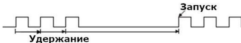
Параметр **Start Holdoff On/Положение Задержки** определяет начальную позицию удержания.
