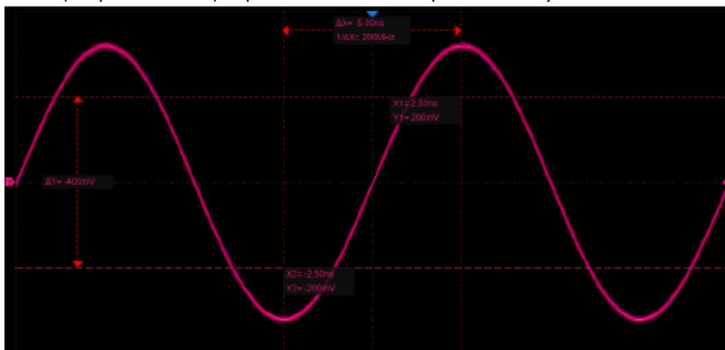
Слежение (Track) - Тип курсора автоматически устанавливается на «горизонтальный + вертикальный». В этом режиме настраиваются только горизонтальные курсоры, а вертикальные курсоры автоматически прикрепляются к точке пересечения курсора и формы сигнала источника.
