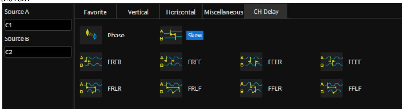
В области выбора параметров сначала указывается канал, соответствующий источнику A, а затем канал, соответствующий источнику B. Наконец, выбирается параметр измерения. Например, чтобы активировать измерение смещения между C1 и C2, необходимо выполнить следующие шаги:
