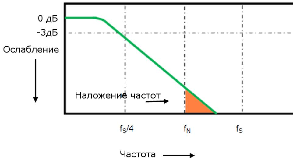
Ограничение полосы пропускания осциллографа ( $F_{bw}$ )  $1/4$  частоты дискретизации ( $F_s/4$ ) уменьшает частотные компоненты выше частоты Найквиста ( $F_n$ )
