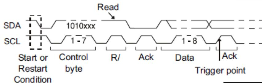
**7- bit Address & Data Condition** - запуск выполняется по кадру Read или Write в 7 - битном режиме адресации на 17-м или 26-м фронте сигнала SCL, если все биты соответствуют шаблону.
