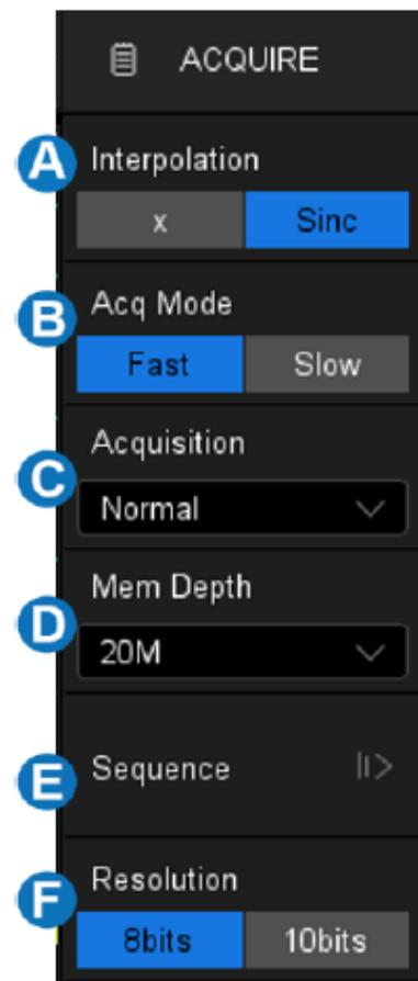
**Глубина памяти:** В осциллографах серии АКИП-4129 объем памяти на канал составляет 100 МБ, в режиме объединения каналов максимальная память составляет 200 МБ. Глубина памяти обозначает количество точек сигнала, которые осциллограф может захватить за один запуск.
