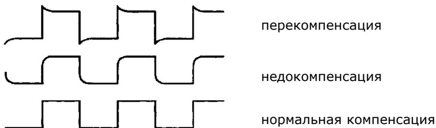
При необходимости, используя неметаллический инструмент, вращением подстроечного конденсатора пробника добиться наиболее правильного изображения меандра на экране осциллографа.
