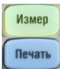
**ИЗМЕР** Включает / отключает измерения и вызывает диалоговое окно ИЗМЕРЕНИЕ.
