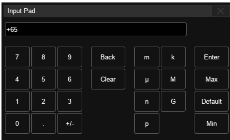
В качестве примера рассмотрен порядок действий для настройки параметра Deskew/Выравнивание аналогового канала: если ожидаемое значение смещения составляет 65 нс, введите «65» на виртуальной клавиатуре, а затем выберите единицу n, чтобы завершить операцию. На виртуальной клавиатуре прикосновение к кнопкам **Max**, **Min** и **Default** быстро устанавливает для параметра максимальное, минимальное значение и значение по умолчанию.
