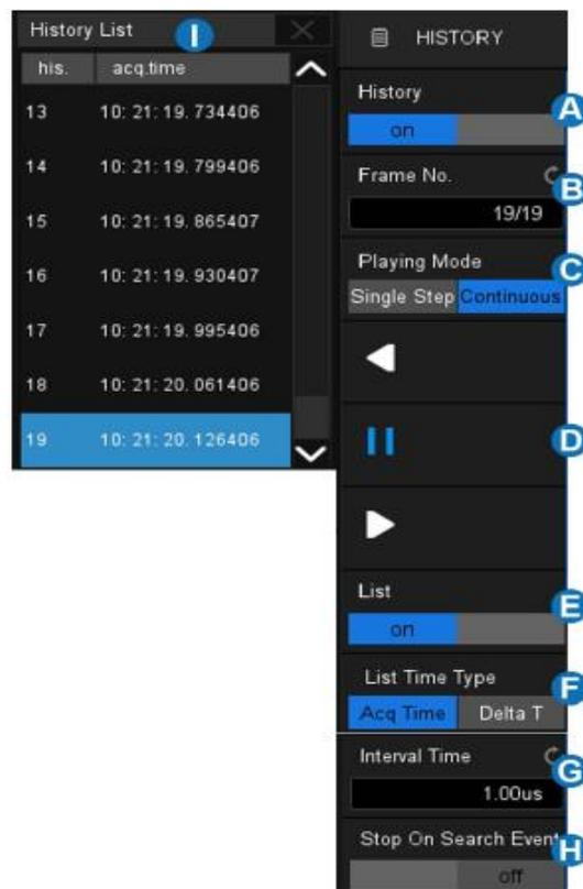
Осциллограф автоматически сохраняет полученные кадры. Он может хранить до 90 000 кадров, но их количество может варьироваться в зависимости от глубины памяти и настроек коэффициента отклонения. Включите режим истории, тогда сохраненные кадры могут быть вызваны и измерены.
