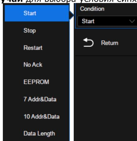
**Start/Старт** – запуск выполняется когда данные SDA переходят из состояния ВЫСОКИЙ в состояние НИЗКИЙ, при этом данные SCL в состоянии ВЫСОКИЙ.
