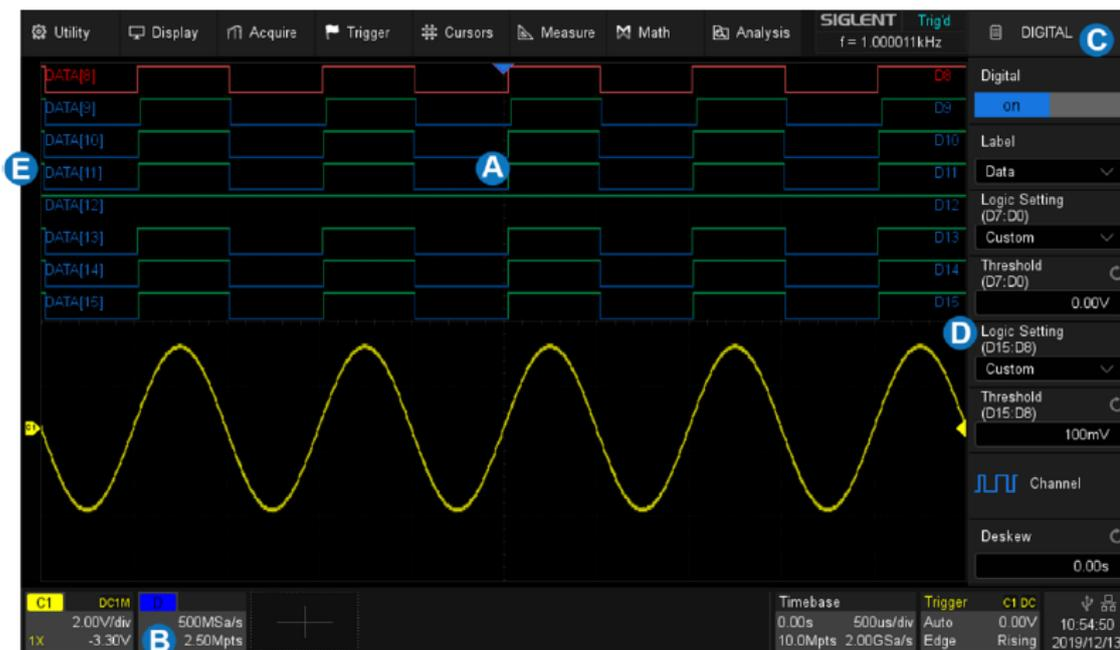
Рис. 29-1 Окно осциллографа в режиме логического анализатора
