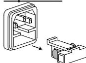
После установки исправного предохранителя - собрать в обратной последовательности.
