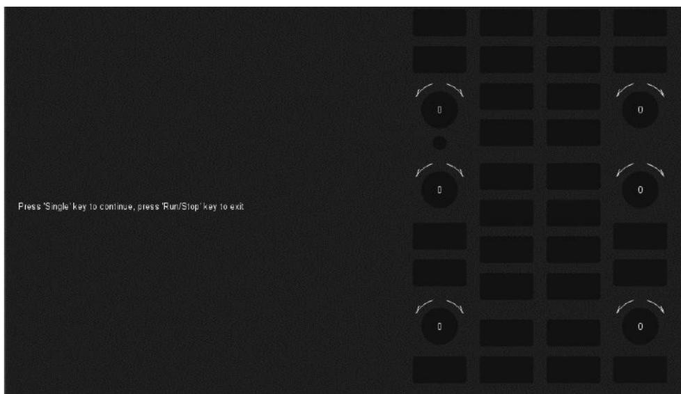
Нажмите кнопку **Однокр**, и загорится первый светодиод на передней панели. Соответствующее положение клавиши на экране также изменит цвет. Нажмите кнопку **Однокр**, чтобы проверить следующую кнопку. Последовательно нажимайте кнопку **Однокр**, пока не будут проверены все кнопки
