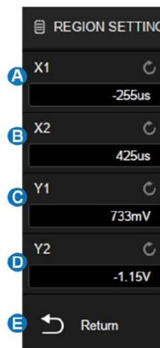
**Примечание.** Если обе области, Область1 и Область2, включены результат логической операции «И» в двух зонах становится определяющим условием срабатывания запуска.
