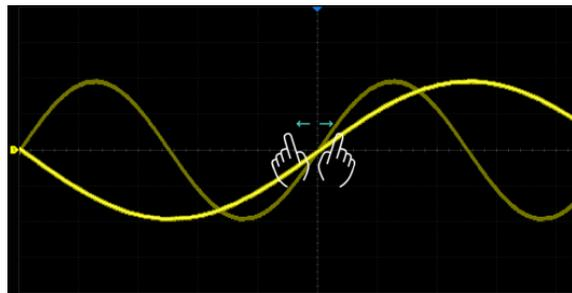
Сжатие и растяжение сигнала по горизонтали, чтобы изменить масштаб временной шкалы
