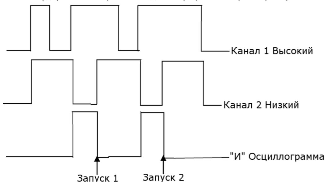
1. Нажать кнопку **Меню Синхр** на передней панели прибора, для перехода в меню настроек синхронизации.
