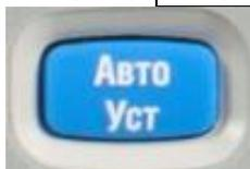
Кнопка автоматического поиска сигнала и установки оптимального размера изображения на экране.
