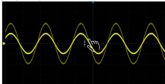
Сжатие и растяжение сигнала по вертикали, чтобы изменить масштаб вертикального усиления
