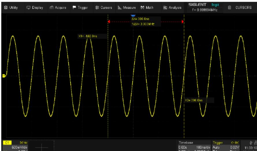
В качестве опорной точки выбрано фиксированное положение. Коэффициент развертки установлен на 100 нс/дел. Положение курсоров относительно сетки экрана остается неизменным, X -1 деление и 2 деления. При этом положение во временной области изменилось, X -100 нс и 200 нс.
