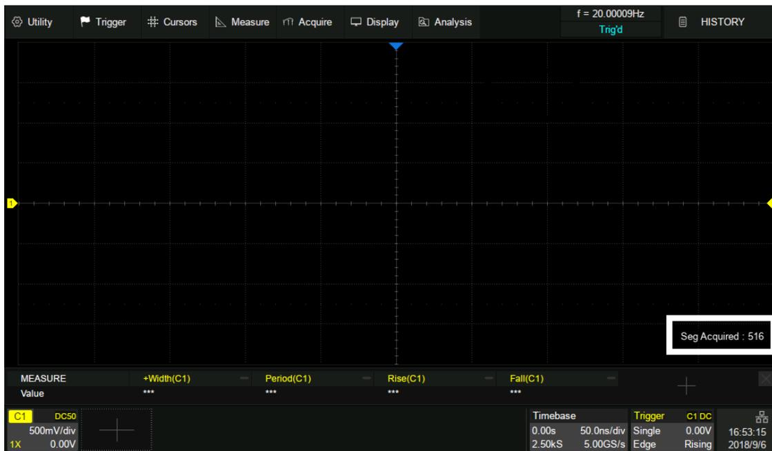
В режиме «**Sequence/Сегментированная память**» сигнал не отображается на экране до тех пор, пока не будет завершен захват данных. Во время сбора данных на экране отображается счетчик, показывающий количество полученных сегментов.
