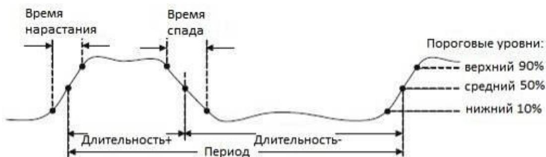
**Period/Период:** Период сигнала ( $T$ ) – интервал между двумя последовательными точками на фронтах одинаковой полярности, взятыми на среднем пороговом уровне (50%).
