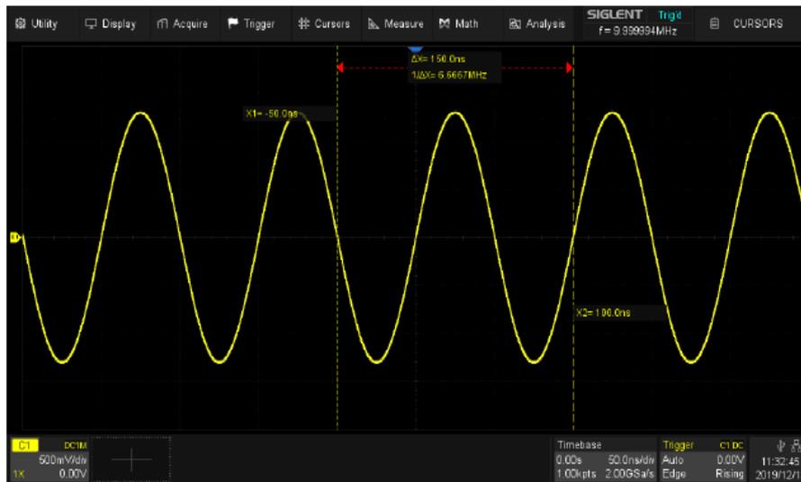
Коэффициент развертки 50 нс/дел, X1= -50 нс = -1дел, X2 = 100 нс = 2дел
