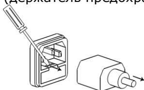
Предохранитель хранится в корпусе держателя. Извлечь - по стрелке.
