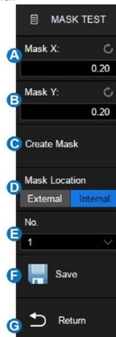
Установите значения для Mask X и Mask Y (в делениях отображаемой сетки), а затем коснитесь пункта Create Mask/Создать, чтобы сгенерировать маску. Диапазон регулировки по горизонтали и вертикали составляет 0,08 ~ 4,00 дел.
