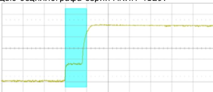
При использовании простой синхронизации по фронту сигналу зафиксировать аномалию будет весьма маловероятно. Благодаря высокой скорости обновления, можно увидеть аномалию, если включить режим послесвечения.
