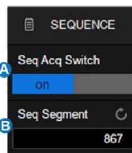
Режим сегментированной памяти является одним из режимов сбора данных, при котором не вся обрабатываемая АЦП информация выводится на экран. В результате максимальная скорость захвата может быть более 500 000 осциллограмм/с, а вероятность регистрации коротких выбросов в этом случае значительно повышается.
