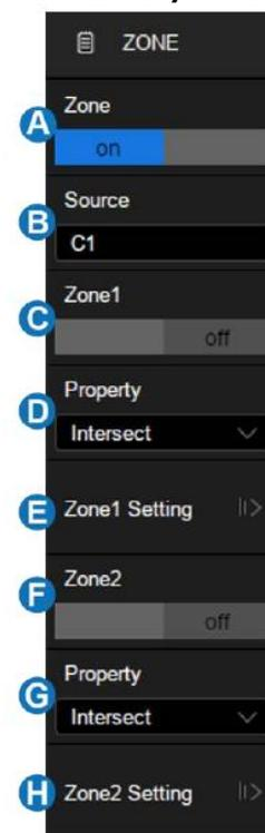
Область можно создать с помощью жестов или через меню настройки **Zone/Область > Zone Setting/Обл Устан**. Цвет контура области соответствует цвету канала выбранного в качестве источника.
