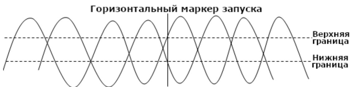
Есть два вида окон: абсолютное и относительное. Окна имеют различные методы корректировки уровня запуска. При выборе окна абсолютного типа, нижний и верхний уровень запуска можно регулировать соответственно с помощью ручки регулятора установки уровня. При выборе окна относительного типа, доступна регулировка центральной оси уровня запуска, и значение отстройки нижней и верхней границ от центра.
