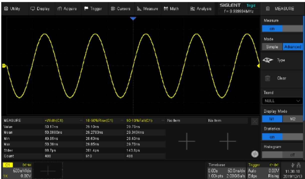
В режиме M2 одновременно отображается до 12 измерений параметров. Когда статистика включена, она распределяется в правой части элемента измерения. Коснитесь Для добавления нового измерения необходимо коснуться пустой строки.
