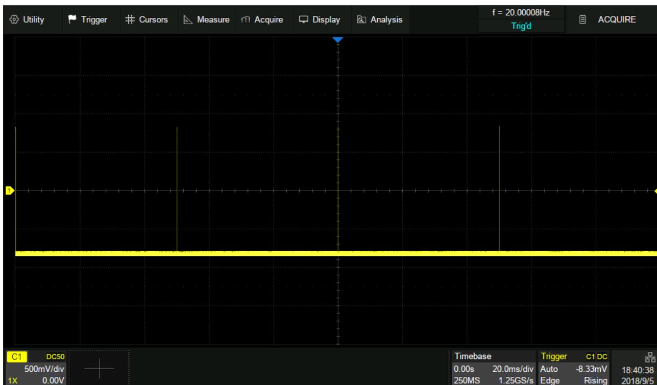
В обычном режиме на экране можно получить 5 импульсов с частотой дискретизации 1 ГГц при максимальной глубине памяти.
