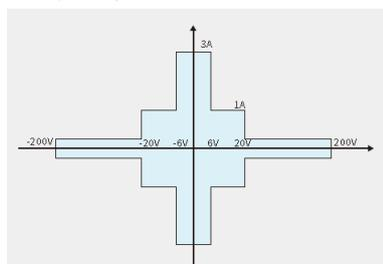
ВАХ АК ИП-1601/3 (-1601/3R) на рис. Пост./DC –слева, Импульс – справа
