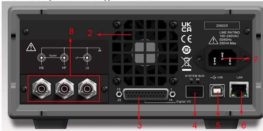
Гнездо для подключения сетевого шнура питания, интерфейсы дистанционного управления USB, LAN, (опция GPIB), оптический интерфейс для построения многоканальной измерительной системы/System Bus, измерительные триаксиальные гнезда (на рис. выше **№8**).
