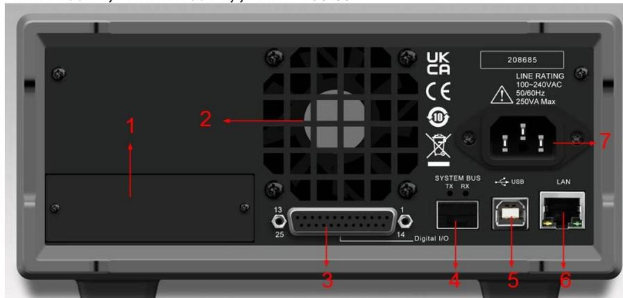
Гнездо для подключения сетевого шнура питания, интерфейсы дистанционного управления USB, LAN, (опция GPIB), оптический интерфейс для построения многоканальной измерительной системы/System Bus (на рис. №№ 1-7).
