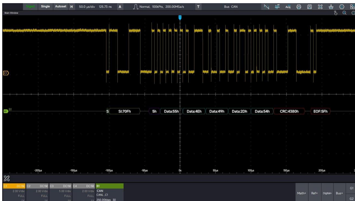
Рис. 14-14 Пример декодирования CAN
