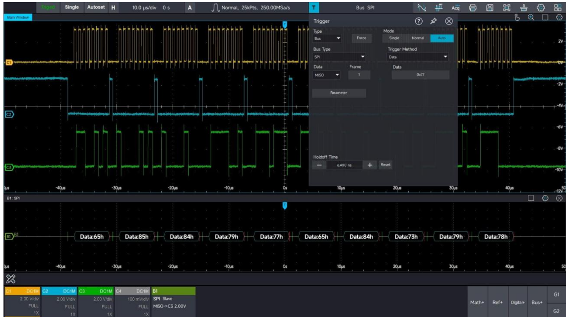
Рис. 13-8 Пример отображения синхронизированного сигнала SPI
