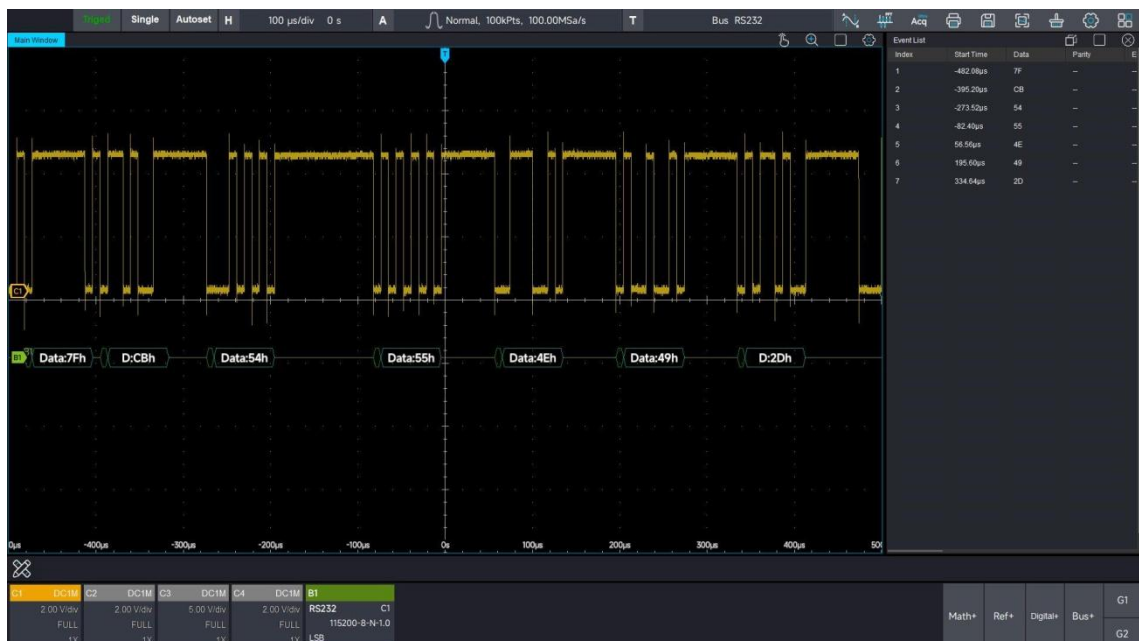
Рис. 14-5 Пример декодирования RS-232
