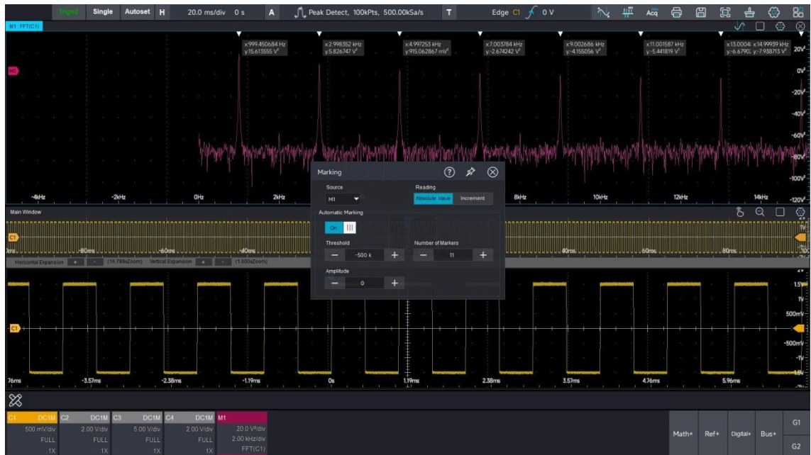
Рис. 17-4 Маркеры пиков в режиме БПФ
