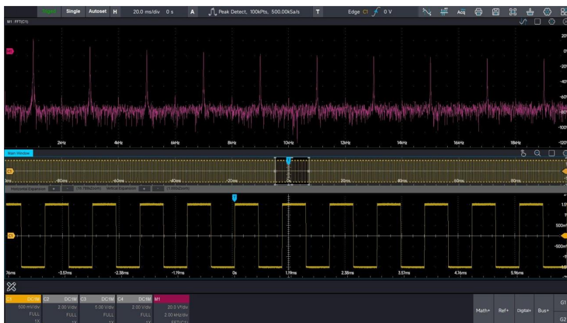
Рис. 17-3 Пример отображения спектра сигнала в режиме БПФ
