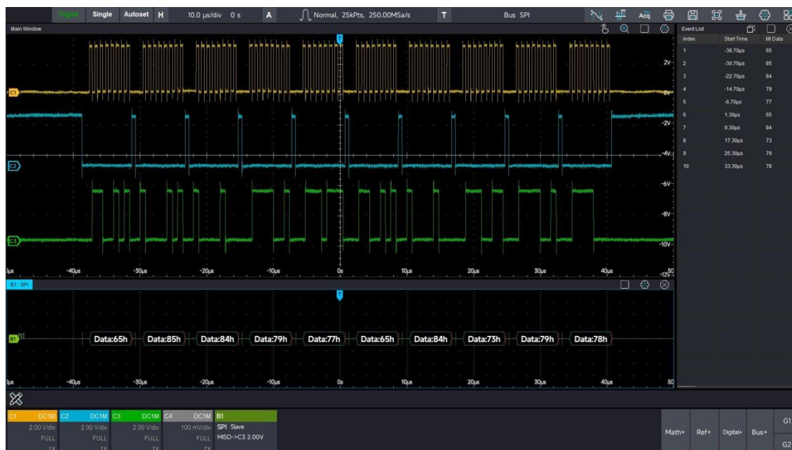
Рис. 14-11 Пример декодирования SPI
