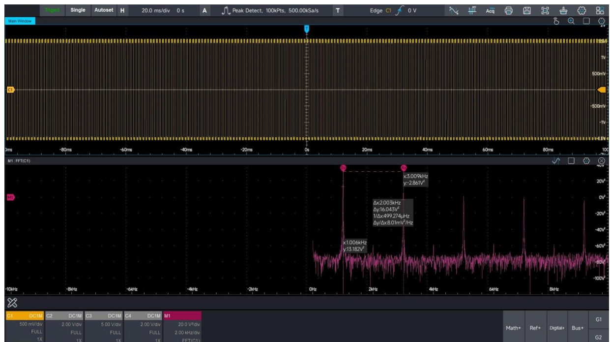
Рис. 16-3 Курсорные измерения в частотной области
