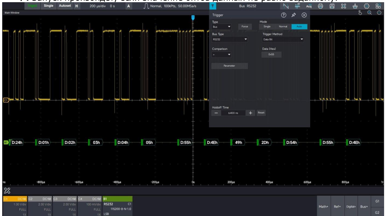
Рис. 13-4 Пример отображения синхронизированного сигнала UART/RS232
