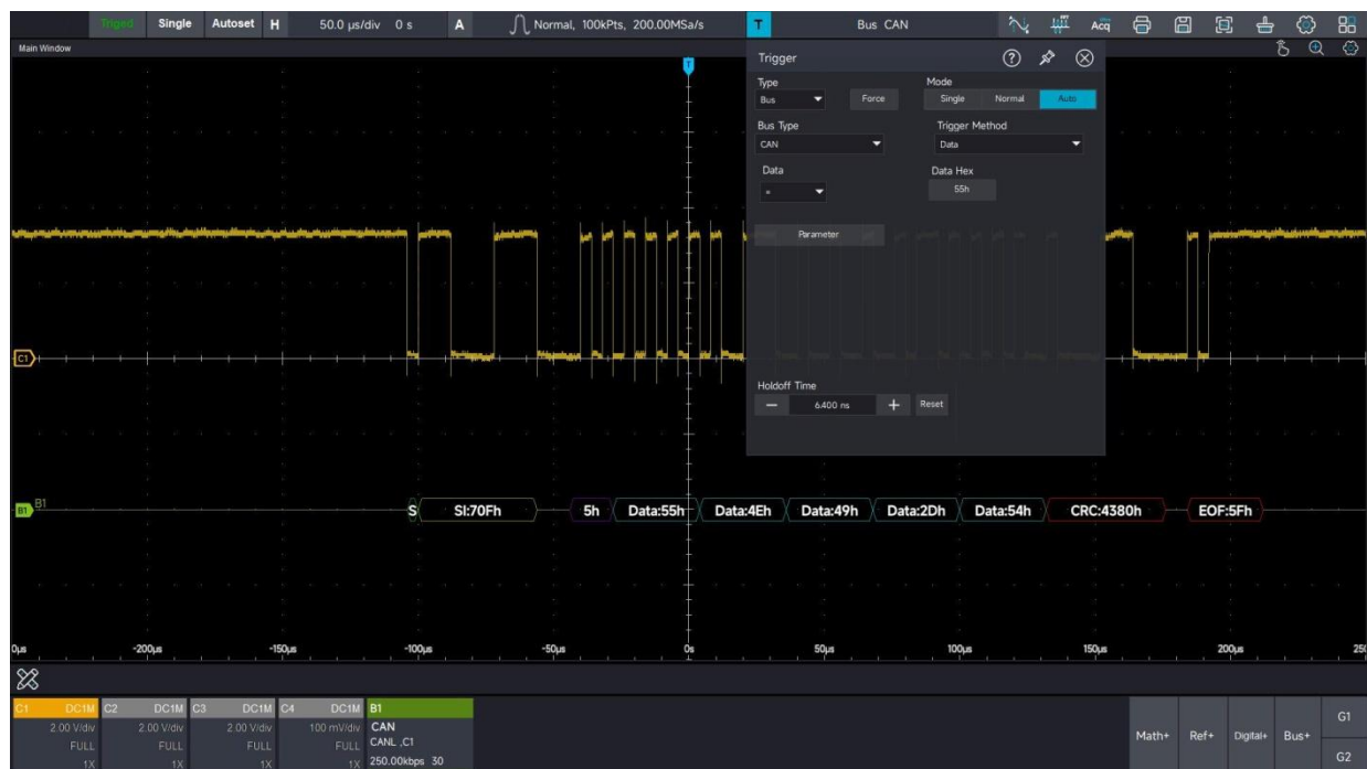
Рис. 13-10 Пример отображения синхронизированного сигнала CAN
