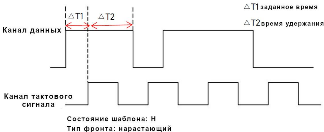
Рис. 12-17 Схема синхронизации по времени и удержанию
