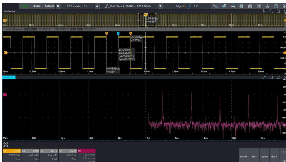
Рис. 16-2 Курсорные измерения во временной области
