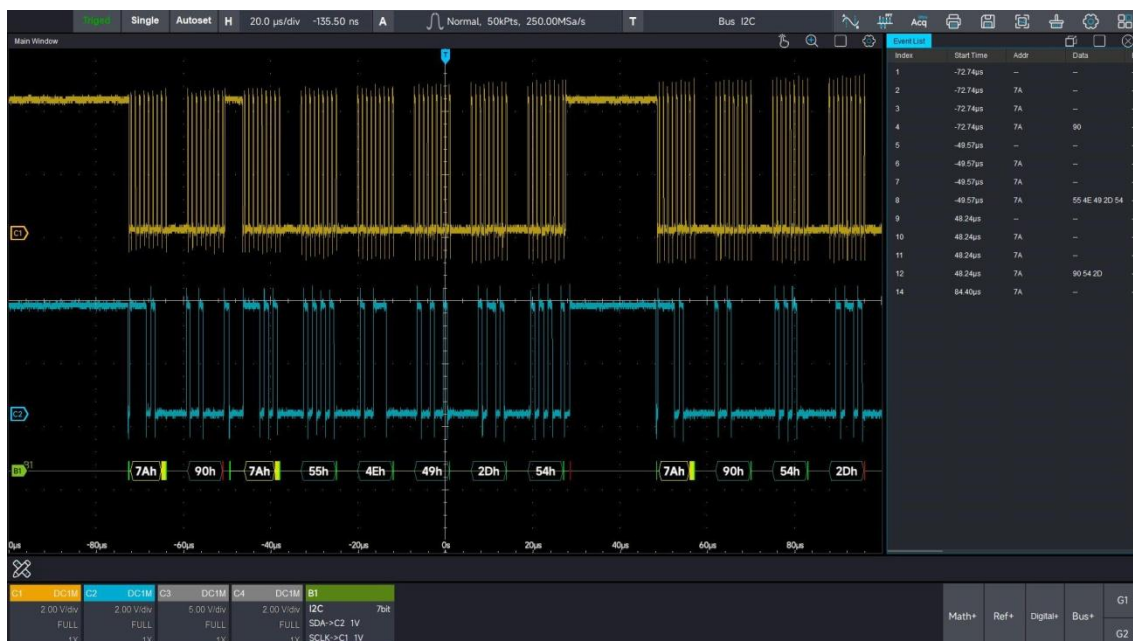
Рис. 14-8 Пример декодирования I 2 C
