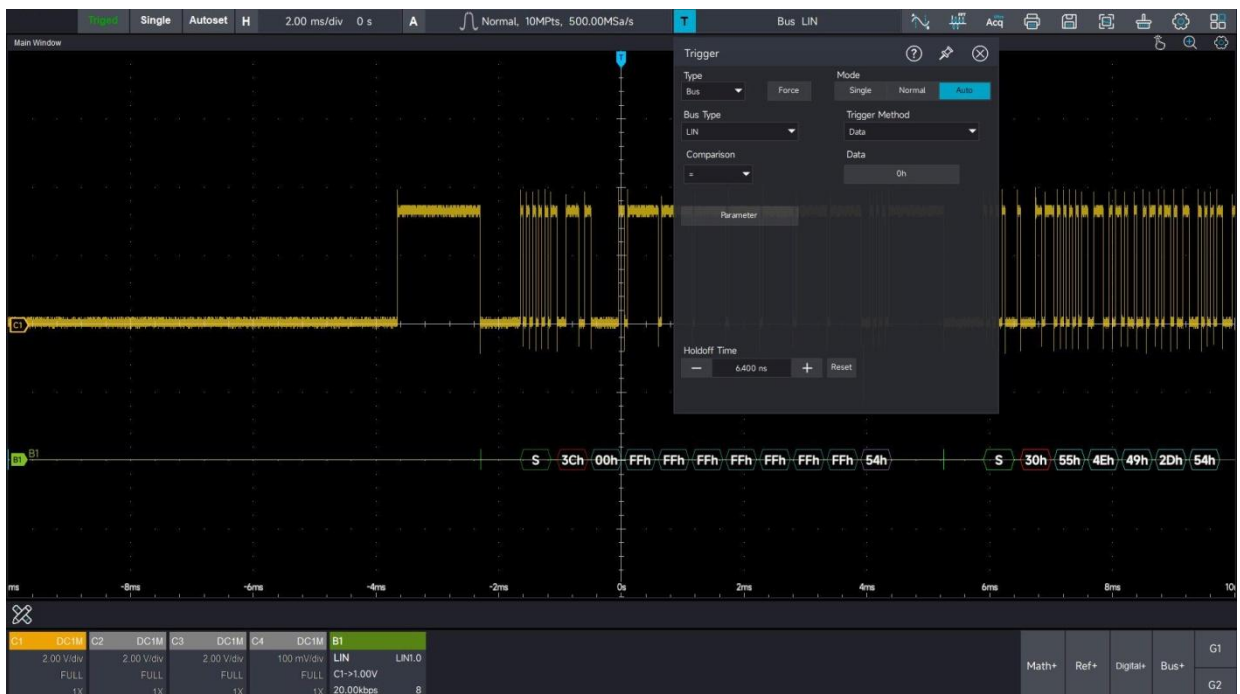
Рис. 13-12 Пример отображения синхронизированного сигнала LIN
