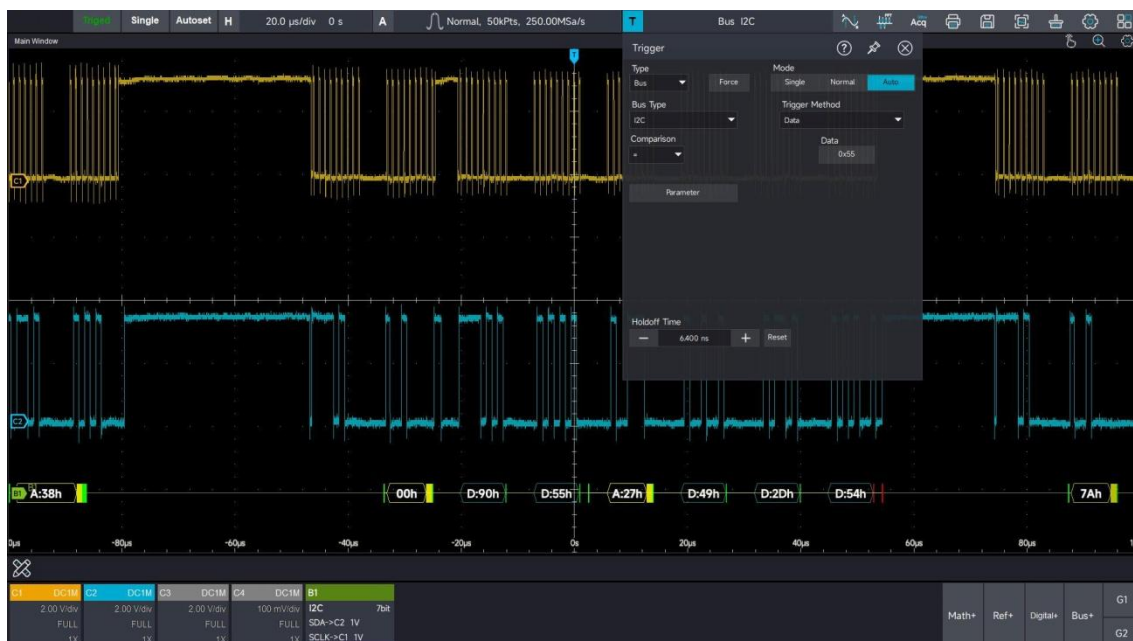
Рис. 13-6 Пример отображения синхронизированного сигнала I2C
