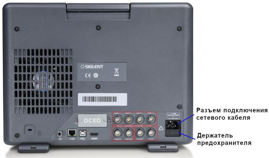
Рис. 5-3 Подключение кабеля питания
