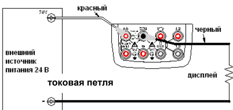
Рисунок 9. Формирование постоянного тока в токовой петле с внешним источником питания
