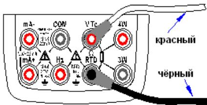
Рисунок 8. Выход сигналов в режиме формирования сопротивления и RTD
