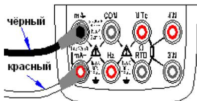
Рисунок 7. Выход сигналов в режиме формирования постоянного тока
