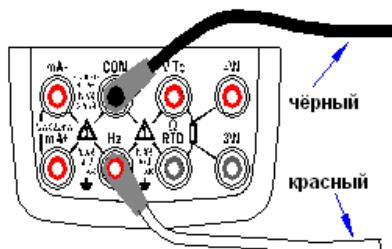
Рисунок 9. Выход сигналов в режиме формирования частоты, числа импульсов и управления внешними цепями
