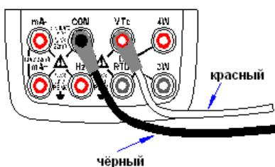
Рисунок 6: Выход сигналов в режиме формирования напряжения постоянного тока и статической характеристики термопар
