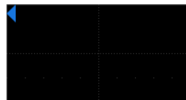
Маркер горизонтального положения нуля, в положении когда он находится за экраном.
