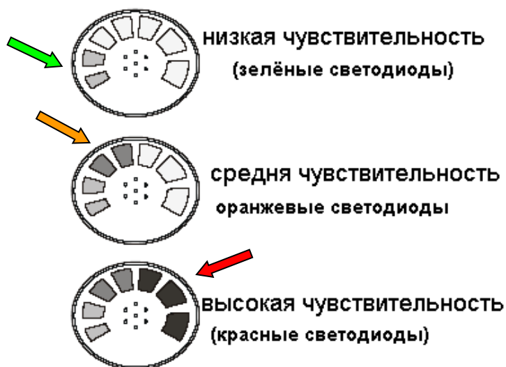
Рис.5 Состояние индикации СДИ (зеленый / оранжевый/ красный)
