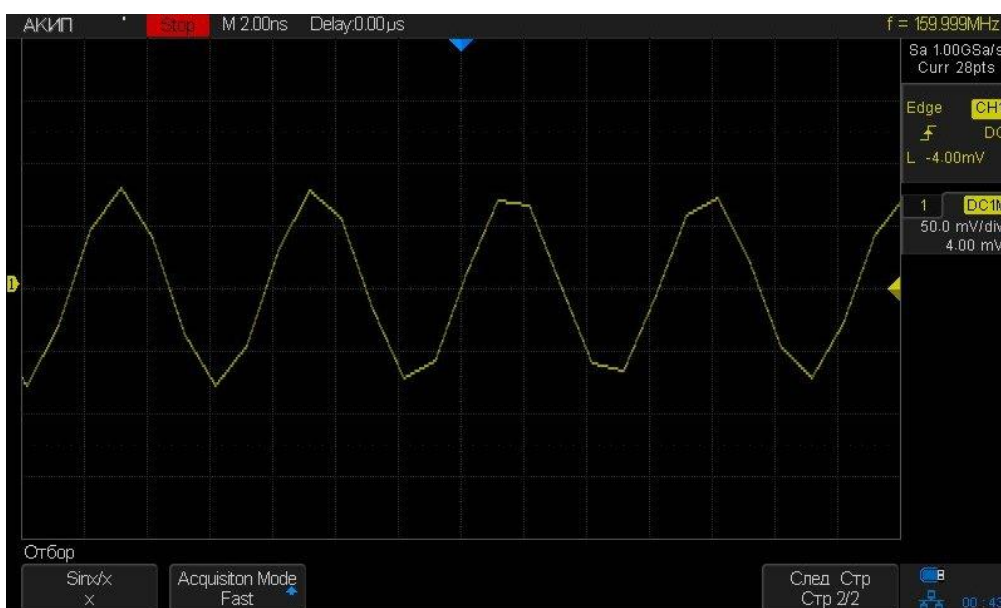
Рис. 10-2 Тип интерполяции – X
