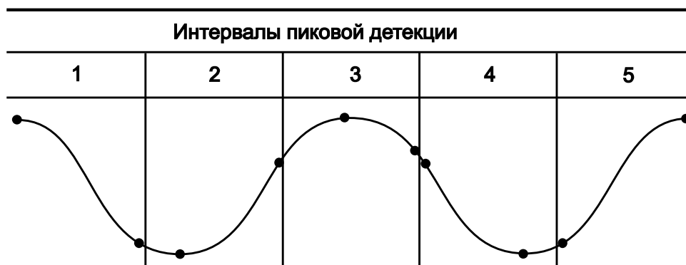
Рис. 10-5 Принцип формирования выборок пикового детектора
