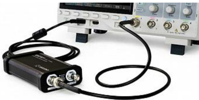
Рис. 22-1 Общий вид осциллографа с подключенным модулем генератора
