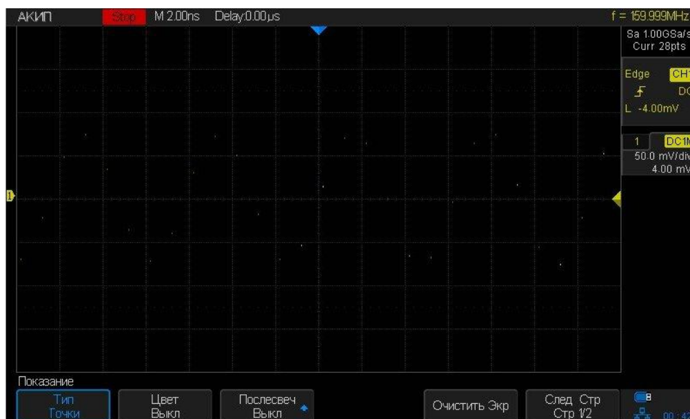
Рис. 10-1 Тип отображения сигнала – Точки
