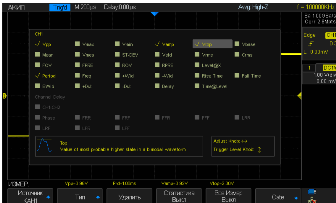
Рис. 16-5 Выбор типа автоматического измерения
