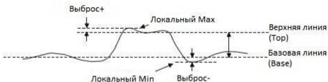
Рис. 16-2 Выбросы на импульсном сигнале
