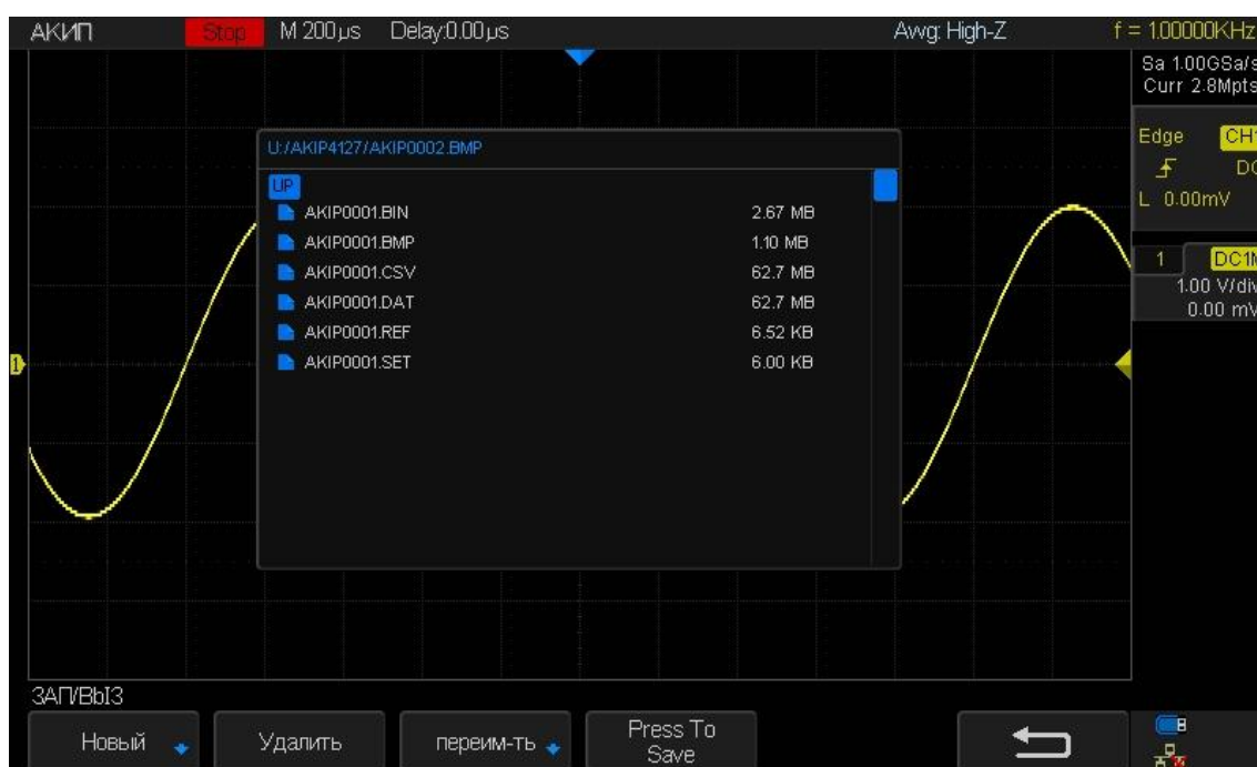
Рис. 18-1 Пример файловой системы USB диска
