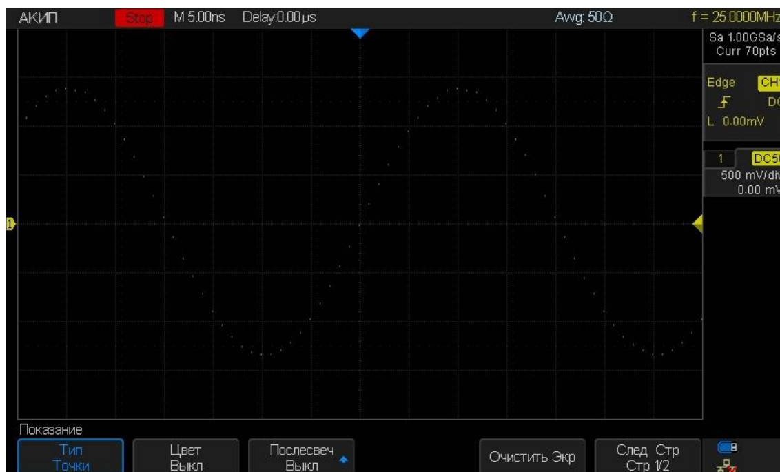
Рис. 17-2 Точечное отображение сигнала
