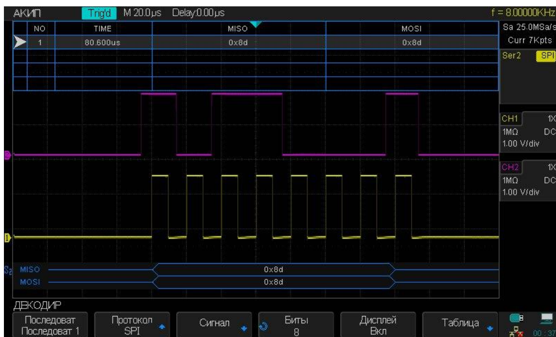
Рис. 12-11 Пример результата декодирования сигнала SPI
