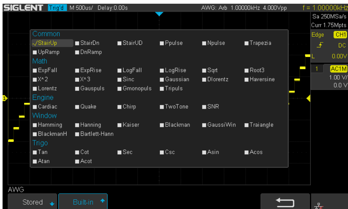
Рис. 22-3 Окно выбора встроенных сигналов произвольной формы
