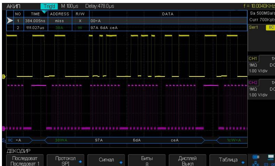
Рис. 12-4 Пример результата декодирования сигнала I2C
