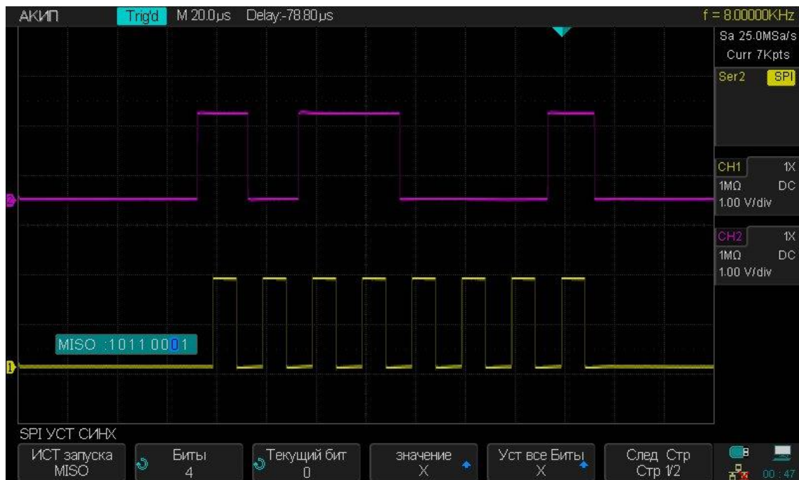
Рис. 12-9 Пример синхронизации по шине SPI
