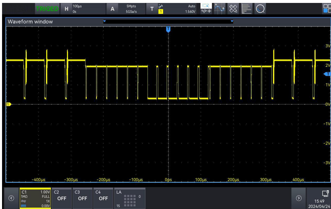
Рис. 12-6 Пример синхронизации по параметрам ТВ сигнала
