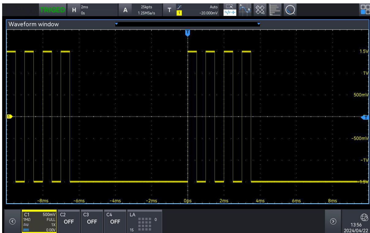
Рис. 12-2 Синхронизация с удержанием запуска
