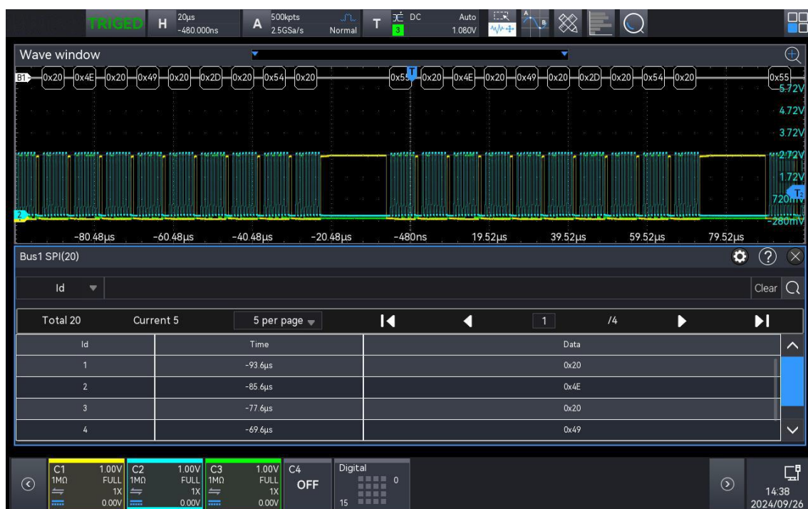
Рис. 14-9 Пример таблицы декодированных данных SPI
