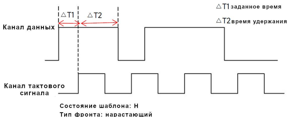
Рис. 12-18 Схема синхронизации по времени и удержанию
