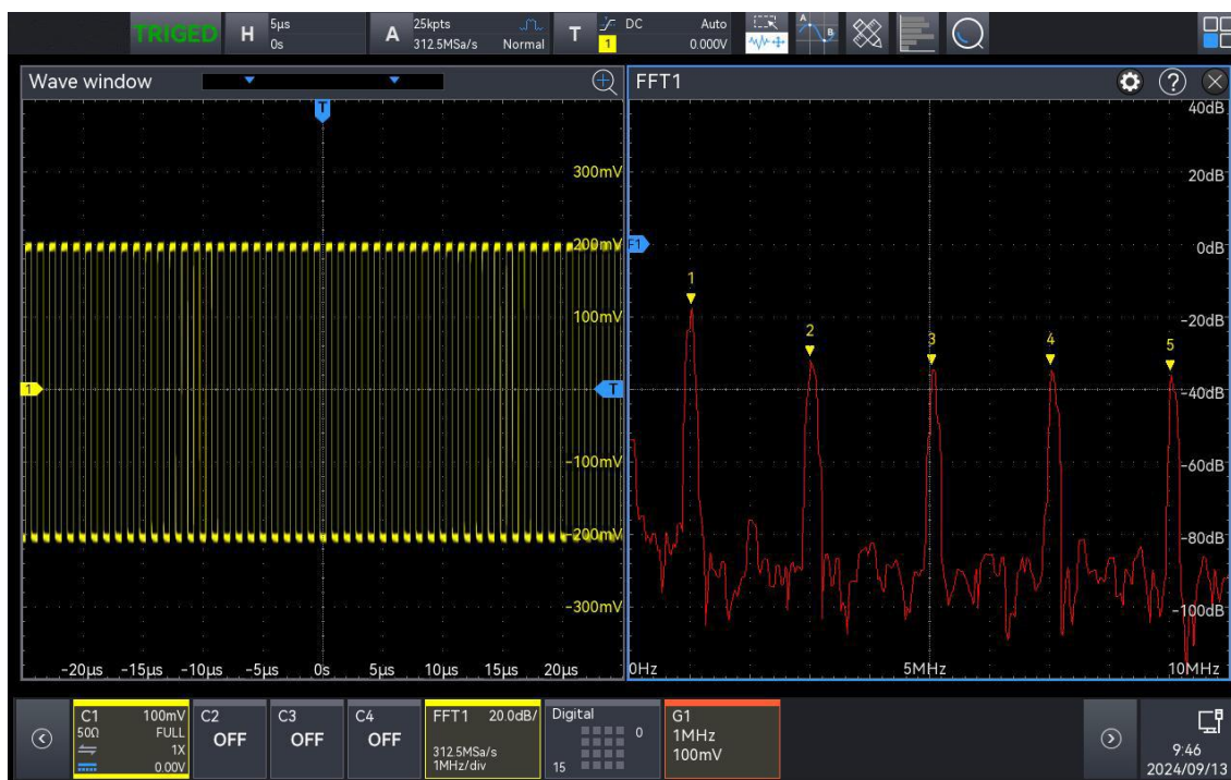
Рис. 16-4 Экран осциллограф в режиме БПФ
