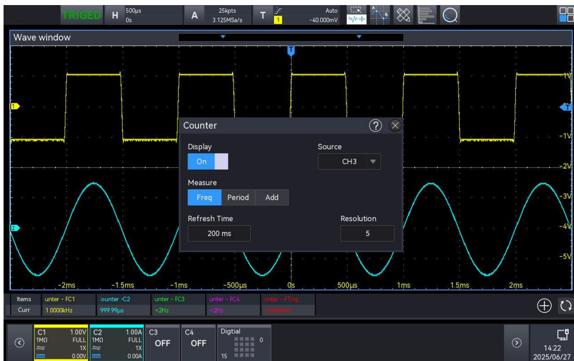
Рис. 15-2 Экран осциллографа с открытым окном настройки частотомера
