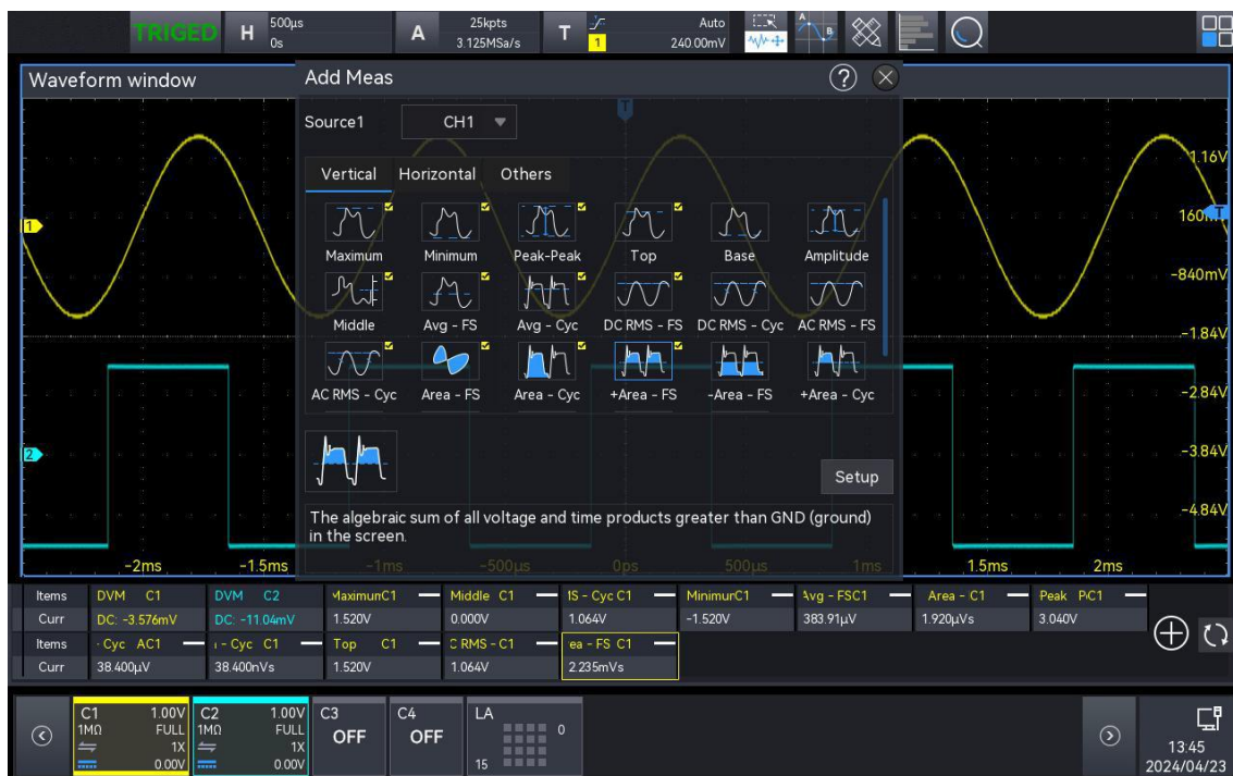
Рис. 15-5 Экран осциллографа в режиме пользовательских измерений
