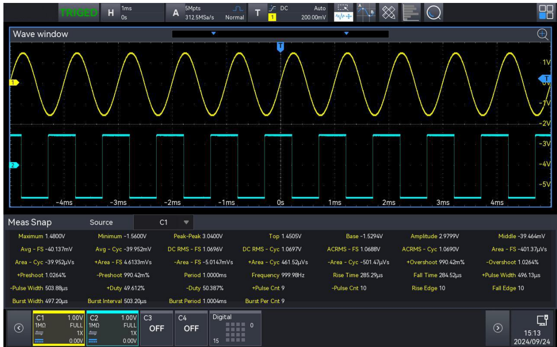
Рис. 15-4 Экран осциллографа в режиме отображения всех измерений для канала 1
