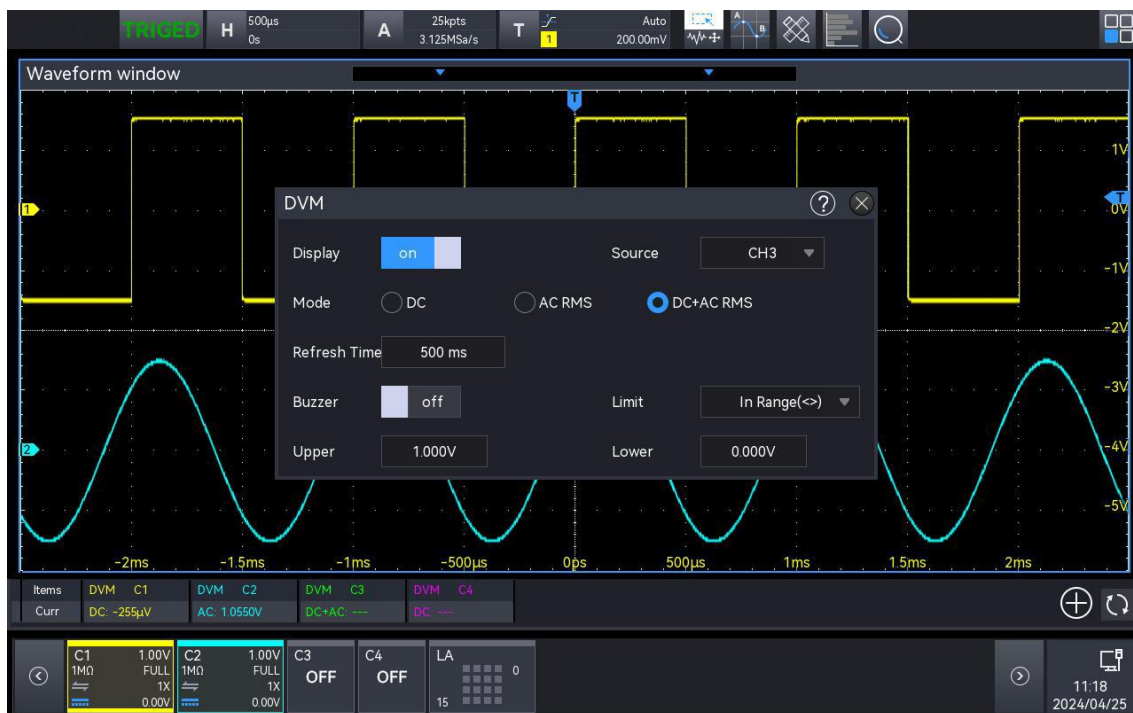
Рис. 15-3 Экран осциллографа с открытым окном настройки вольтметра
