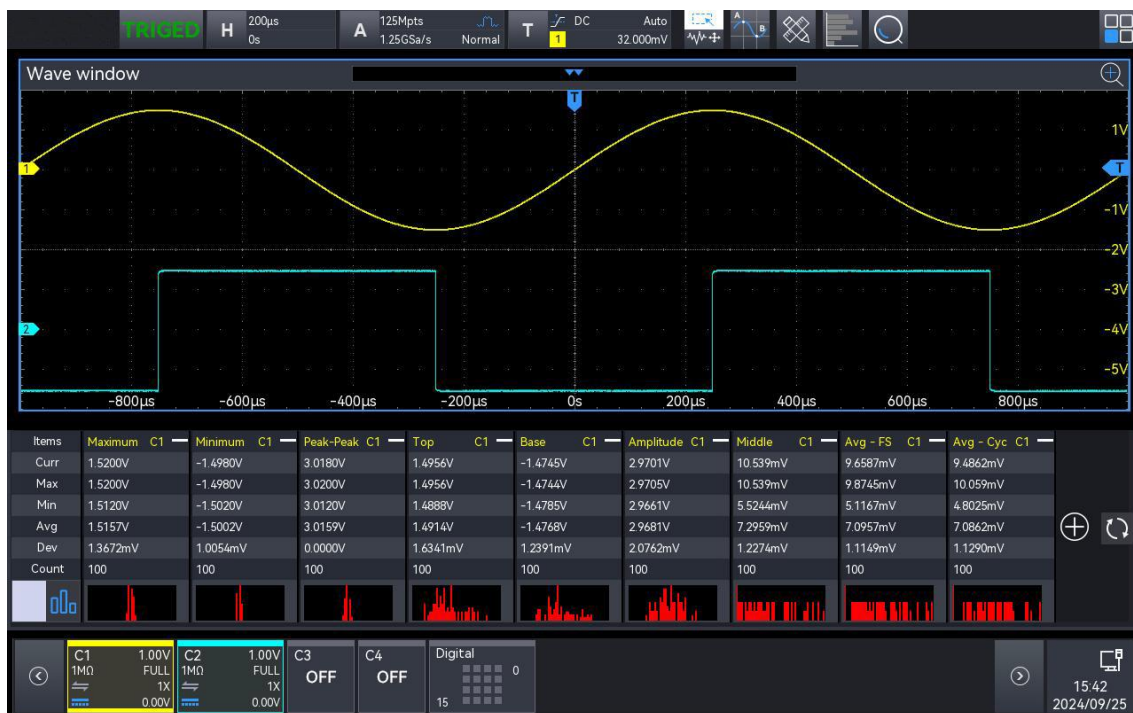
Рис. 15-6 Экран осциллографа в режиме вывода статистики измерений
