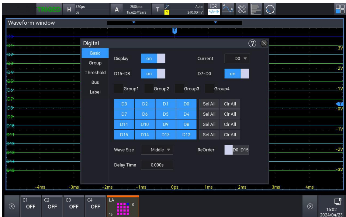
Рис. 22-1 Отображение цифровых каналов
