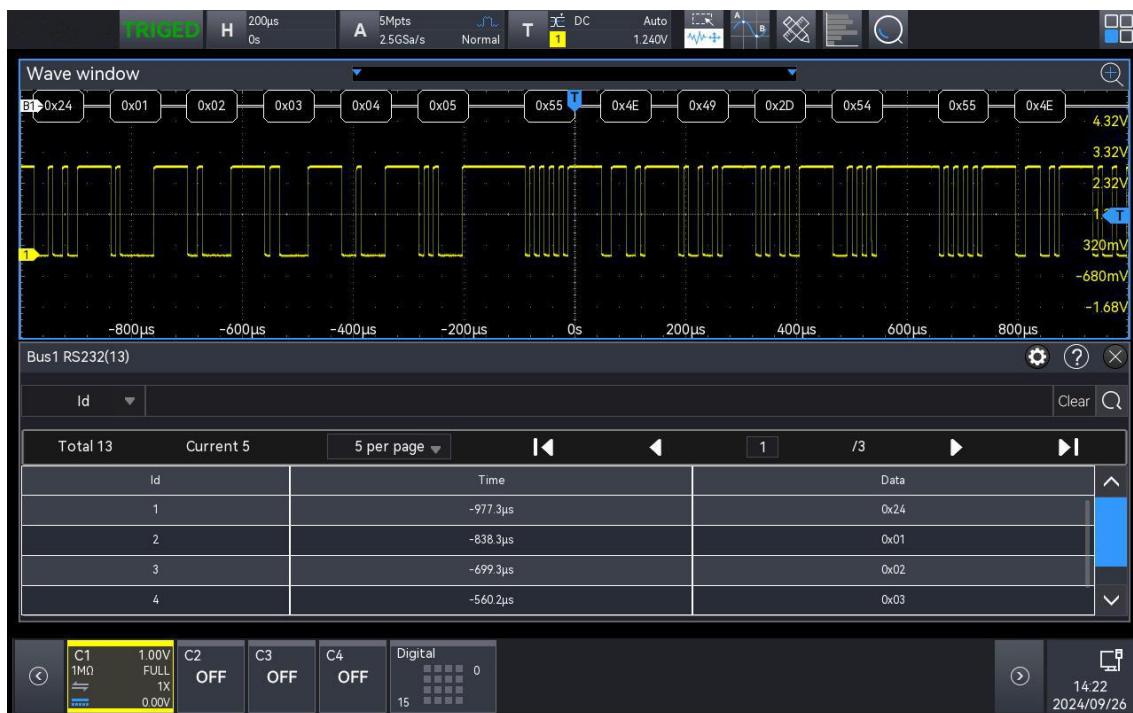
Рис. 14-3 Пример таблицы декодированных данных RS232
