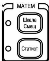
Меню функции математики доступно только при измерении частоты. Функция включает режим математических расчетов и возможность статистической обработки результатов.
