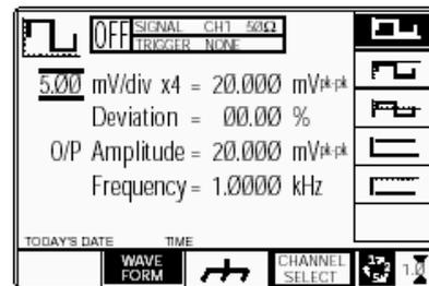
Метка кнопки «**WAVEFORM**» (**ФОРМА СИГНАЛА**) подсвечена, чтобы указать, что выбор сигнала разрешен, также как символ текущего выбранного сигнала. Нажатие одной из сигнальных кнопок (например: кнопки для выбора другой формы сигнала, возвратит к предыдущему экрану, с символом выбранной формы сигнала в верхнем левом углу:
