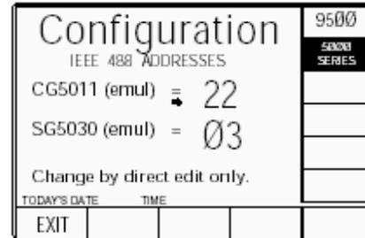
Обратите внимание, что 9500B содержит два IEEE-488 интерфейса, каждый из которых соответствует отдельному адресу. 9500B и CG5011 занимают один IEEE адрес на шине и могут быть модифицированы как на экране 9500B, так и на экране серии 5000. SG5030 занимает другой адрес шины, который может быть модифицирован только на экране 5000 серии. Выбор серии 5000 также переключает интерфейс для приема только команд эмуляции.
