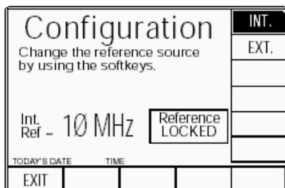
3. При переключении на внешний источник «EXT.», используйте кнопки управления курсором или ручку, чтобы указать калибратору 9500В частоту источника. Убедитесь, что требуемый источник подключен и включен.
