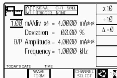
Приведенный выше и устанавливаемый по умолчанию экран, автоматически выбирает симметричный прямоугольный сигнал, на что указывает символ в левом верхнем углу экрана. Частота может изменяться от 10.000 Гц до 100.00 кГц. По умолчанию установлена частота 1 кГц, отклонение (Deviation) «Δ» равно нулю и выходной ток 4.0000 мА (p-p). Сквозность фиксирована при номинальном значении 50%.
