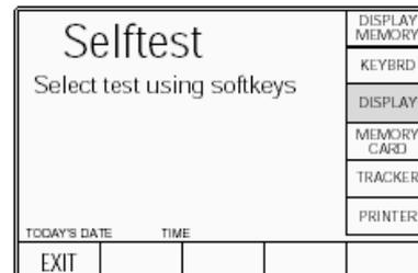
Выбор «DISPLAY» вызывает экран тестирования дисплея «Display test». Он приглашает пользователя использовать клавишу табуляции лицевой панели «tab» (↵) для перемещения черной полосы вниз экрана, вверх и снова вниз, тестируя таким образом все элементы дисплея на экране:
