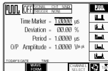
Кнопка «WAVEFORM» (выбор формы сигнала) подсвечивается, чтобы указать, что выбор формы сигнала доступен, также как символ выбранной формы сигнала.
