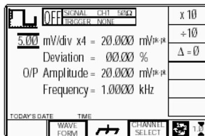
Вышеупомянутый, заданный по умолчанию, экран автоматически выбирает положительный прямоугольный сигнал, что обозначено символом в верхнем левом углу. Частота может изменяться от 10.000 Гц до 100.00 Гц. По умолчанию устанавливается частота 1 кГц, отклонение «Δ» равно нулю и выходное напряжение 20.000 мВ (пик-пик). Скажность фиксирована при номинальном значении 50 %.
