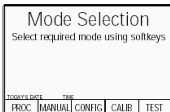
2. Нажмите экранную кнопку «**CONFIG**» в центре нижней строки для перехода к режиму конфигурации «**Configuration**». Калибратор 9500В откроет информационный экран режима конфигурации «**Configuration**»:
