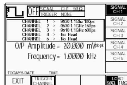
Как можно видеть на экране, головки типа 9530 подключены к каналам 1 и 2, головка типа 9510 подключена к каналу 3, и ничего не подключено к каналам 4 и 5. Подсветка на канале 1 указывает, что этот канал выбран для выхода сигнала, (что подтверждается надписью в центральном верхнем поле). Нажатие любой из функциональных кнопок с правой стороны выберет этот канал для выхода сигнала.
