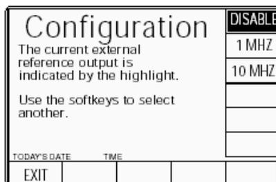
2. Чтобы изменить выходную частоту, нажмите требуемую экранную кнопку справа.
