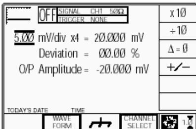
После перехода к функции постоянного напряжения нет необходимости изменять форму сигнала для изменения полярности. Нажатие экранной кнопки +/- переключает полярность постоянного напряжения. Выбранная полярность показывается как символ функции в левом верхнем углу и подтверждается знаком + или - на величине выходной амплитуды (O/P Amplitude).
