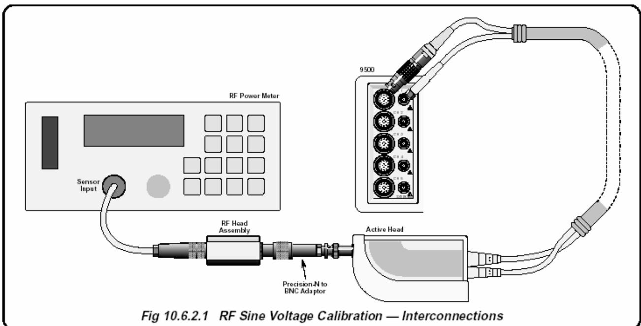
Рис. 10.6.2.1. Калибровка функции ВЧ синусоидального напряжения - межсоединения
