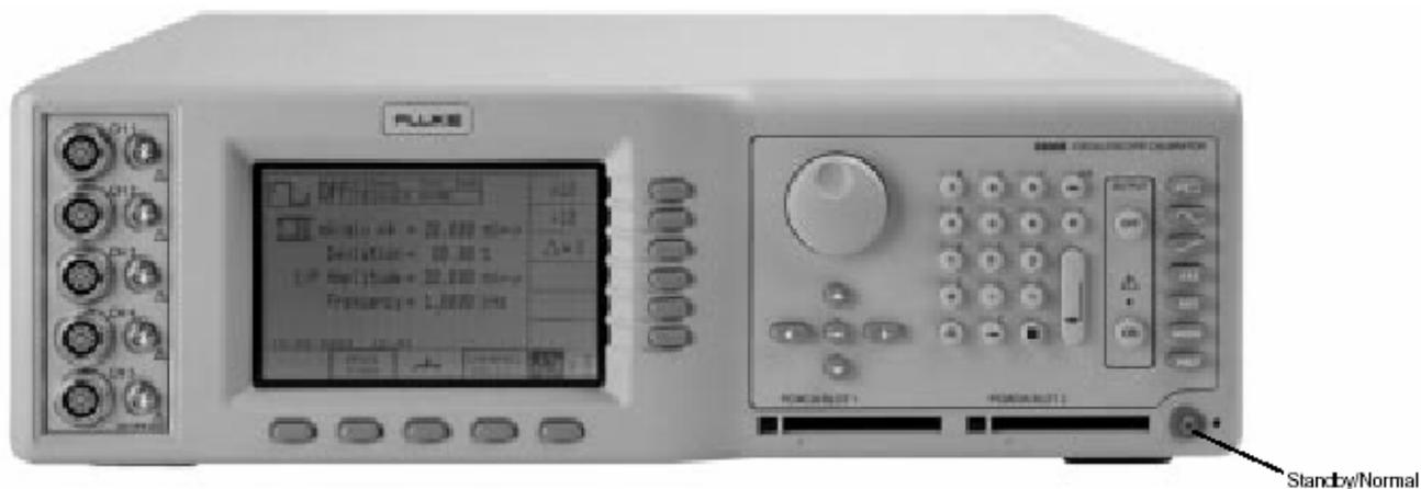
Центр: ЖКИ экран - меню (Menu) и выходные параметры (Output Display), вместе со сгруппированными функциональными кнопками.
