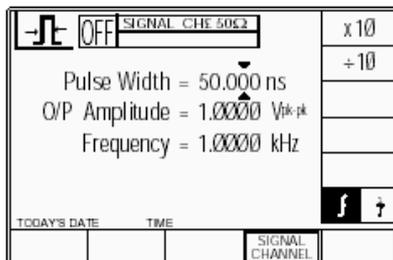
Приведенный выше по умолчанию экран «Pulse Width» устанавливает длительность импульса 50 нс при частоте 1 МГц. Выходная амплитуда фиксирована на напряжении 1 В pk-pk на нагрузке 50 Ом.
