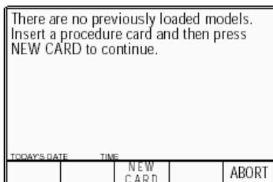
В этом случае, вставьте требуемую для UUT карту в PCMCIA СЛОТ 1, нажмите аккуратно до упора и нажмите экранную кнопку «NEW CARD» для продолжения. 9500В перейдет к экранному меню «Select MANUFACTURER» (Выбрать производителя), если больше, чем один производитель перечислен в карте процедуры, или «Select MODEL» (Выбрать модель), если указан только один изготовитель.
