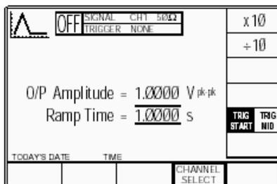
Калибратор 9500В автоматически выбирает время нарастания (Ramp Time) 1.0000 с. Запуск в положении: «TRIG START», не «TRIG MID». Амплитуда «O/P Amplitude» фиксирована на значении 1.0000 В.
