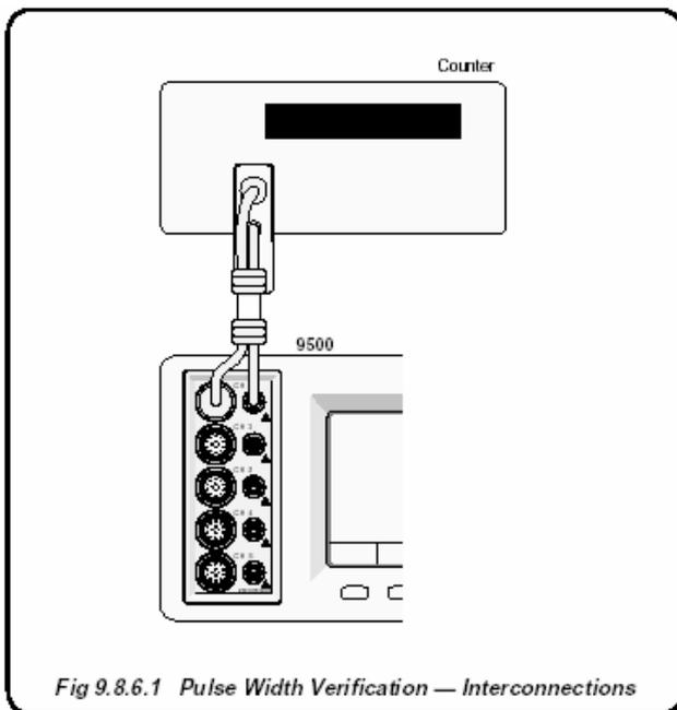
**Рис. 9.8.6.1. Поверка функции длительности импульса - межсоединения**
