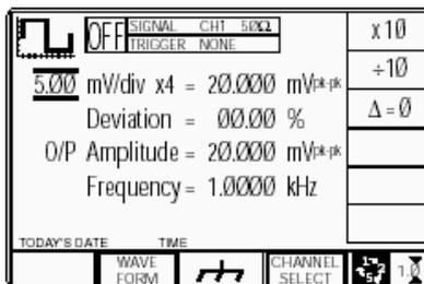
Рис. 4.3.3.2 Экран включения по умолчанию ручного режима — многоканальный
