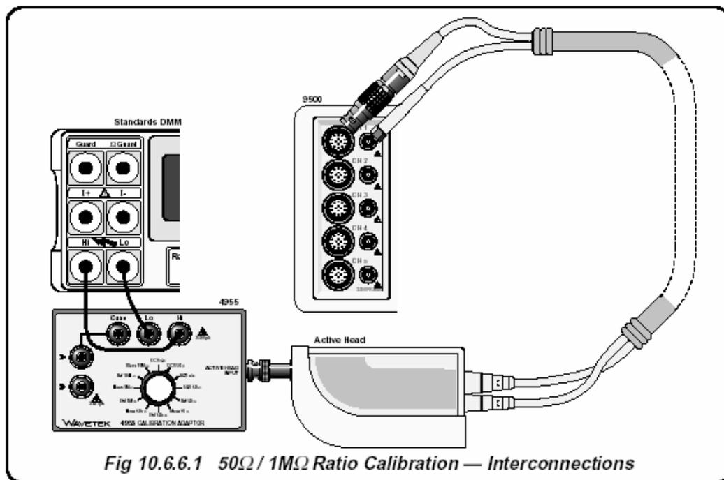
Рис. 10.6.6.1. Калибровка отношения 50 Ом/1 МОм – межсоединения
