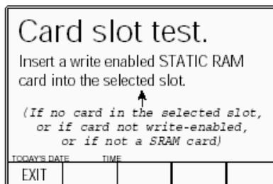
После исправления вышеприведенного, нажмите экранную клавишу «OK». Это приведет к новому экрану и начнется последовательность тестов. Прохождение теста фиксируется на экране. 9500B сначала тестирует состояние внутренней батареи карты. Если напряжение батареи мало, это будет указано на экране:
