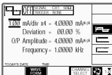
Обе полярности выходного постоянного тока перечислены как различные формы сигналов. Например, нажатие кнопки
