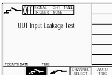
Приведенный выше экран, выбираемый по умолчанию, автоматически выбирает режим с разомкнутой цепью, на что указывает символ в левом верхнем углу экрана и подсвеченной экранной кнопкой в нижней строке.
