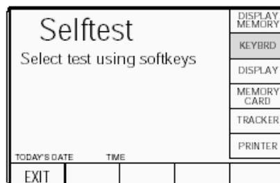
Выбор «KEYBRD» переводит к экрану тестирования клавиатуры «Keyboard test». Он приглашает пользователя нажать тестируемую кнопку на лицевой панели, и не экране появляется отчет о последней нажатой кнопке:
