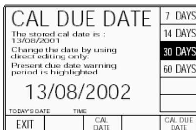
Этот экран также покажет установленную дату калибровки «**CAL DATE**» для вычисления даты последующей калибровки. Если Вы не хотите обновлять дату последующей калибровки «**CAL DUE DATE**», нажмите экранную кнопку «**EXIT**».
