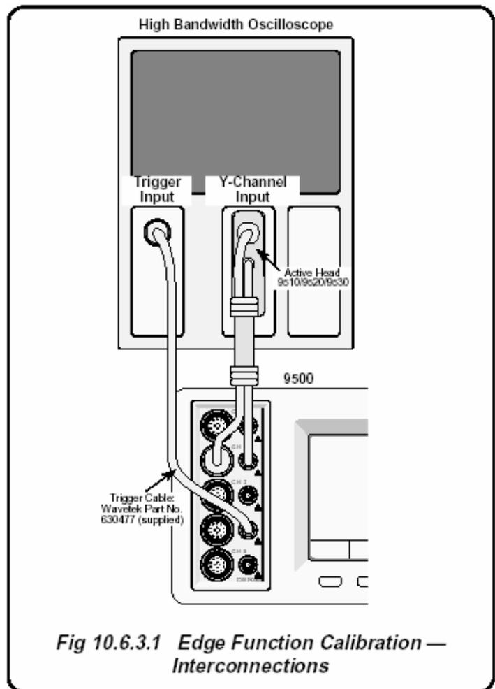
Рис. 10.6.3.1. Калибровка функции импульсного перепада - межсоединения
