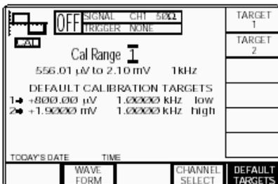
При выборе цели 2 (target 2) нажатием ее кнопки, амплитуда и частота цели (Target Amplitude и Frequency) будут показаны под текущей выходной амплитудой (Output Amplitude), как показано на следующем регулировочном экране (Adjustment):
