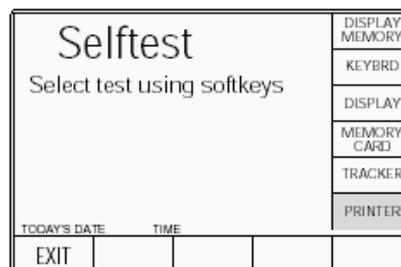
test». Он приглашает пользователя использовать принтер для тестирования интерфейса (т.е. переключая принтер в «off-line», или удаляя бумагу), и сообщений о состоянии принтера:
