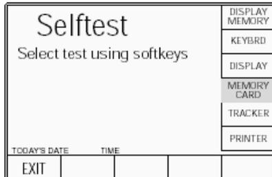
Нажатие кнопки «MEMORY CARD» в меню выбора теста «Select test» приведет к экрану тестирования слота карты «Card slot test». Он приглашает пользователя выбрать тестируемый слот карты памяти и выводит предупреждение «Overwrite» (перезапись):
