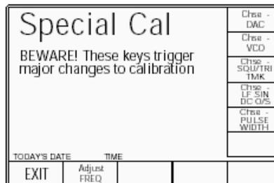
**10.3.4.2 Когда характеризовать** Characterisations (характеризации) - регулировки, которые калибруют основные цифровые выходные источники. Эти регулировки должны быть выполнены непосредственно перед проведением стандартной калибровки 9500B (подробности в следующих подразделах).
