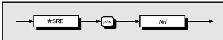
\*SRE допускает стандартные и определяемые пользователем итоговые биты в байте обслуживания запроса, который генерирует запрос на обслуживание. Обратитесь к разделу 6, подраздел 6.5.
