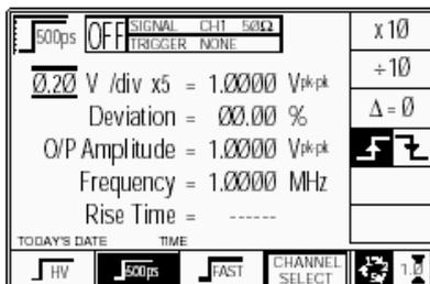
По умолчанию на экране автоматически устанавливается частота 1 МГц, время нарастания 500 пс, отклонение равно нулю и выходной уровень 1 В p-p.
