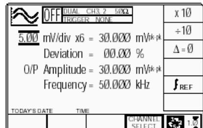
Обратите внимание, что при работе функции сдвоенного канала, верхние амплитудные пределы диапазонов синусоидального сигнала делятся пополам.
