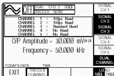
Символы обоих каналов и режима сдвоенного канала будут подсвечены, и надписи в окне в верхней части экрана покажут два выбранных канала, причем главный канал будет написан первым. Нажмите «EXIT» чтобы вернуться к основному экрану режима сдвоенного канала и настроить другие параметры:
