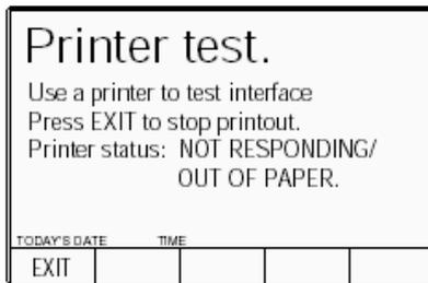
Возможные отклики приведены на рисунке. Они обновляются автоматически при изменении состояния принтера. При правильной работе, принтер будет печатать набор символов непрерывно, пока не будет нажата экранная кнопка «EXIT».
