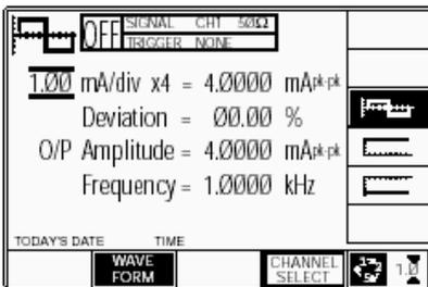
Символы кнопок выбора сигнала и текущей формы сигнала (подсвечены), чтобы указать возможные формы сигнала и текущую форму сигнала. Из симметричных форм доступна только прямоугольная форма сигнала тока, другие формы на этом экране соответствуют постоянному току. После выбора любой из этих форм, система вернется к предыдущему экрану с символом выбранной формы сигнала в левом верхнем углу экрана:
