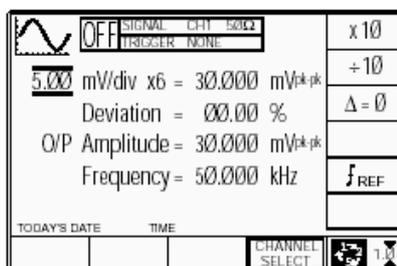
Вышеприведенный экран показывает выбранную по умолчанию частоту 50 кГц. Отклонение установлено равным нулю и выходное напряжение 30.000 мВ (пик-пик).
