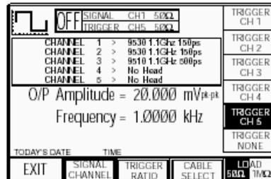
Этот канал должен быть локализован как «кабельный» канал, что можно сделать нажатием кнопки «**CABLE SELECT**». Новый экран будет следующим:
