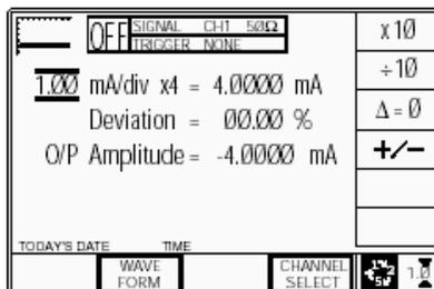
После выбора функции постоянного тока нет необходимости изменять форму сигнала для изменения полярности. Нажатие экранной кнопки «**+/-**» делает переключение между положительными и отрицательными постоянными токами. Выбранная полярность показана символом в верхнем левом углу экрана, подтвержденная знаком «**+**» или «**-**» на величине «**O/P Amplitude**».
