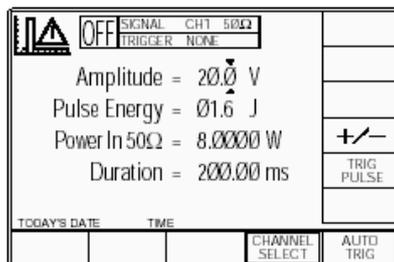
Вышеприведенный экран (по умолчанию) устанавливает импульс положительной полярности, на что указывает символ в верхнем левом углу экрана. Амплитуда изменяется от 5 В до 20 В (по умолчанию). Энергия импульса изменяется от 1.6 Джоуля (по умолчанию) до 50 Джоулей. Мощность на нагрузке 50 Ом и длительность импульса вычисляются из настроек напряжения и энергии импульса.
