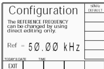
3. Используйте прямое редактирование для установки требуемой опорной частоты. После ввода величины, нажмите клавишу  $\downarrow$  на клавиатуре (экранная кнопка 'V' в правом столбце выполнит то же самое действие).
