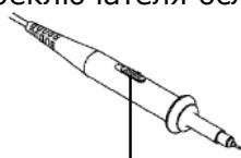
Рис. 7-5 Переключатель ослабления (по стрелке)
