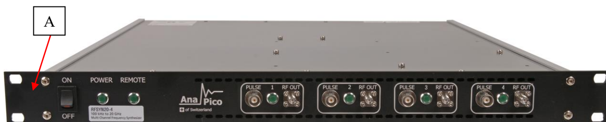
Рисунок 5 – Общий вид модификации RFSYN20-3 и место нанесения знака утверждения типа (А)
