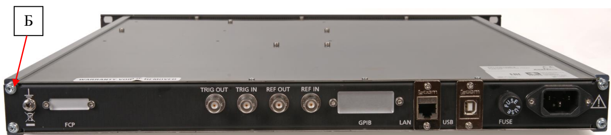
Рисунок 7 – Вид сзади модификаций RFSYN20-1, RFSYN20-2, RFSYN20-3, RFSYN20-4 и схема пломбировки от несанкционированного доступа (Б)
