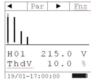
Меню "Fnz" в режиме измерения гармоник напряжения (кнопка F4)
