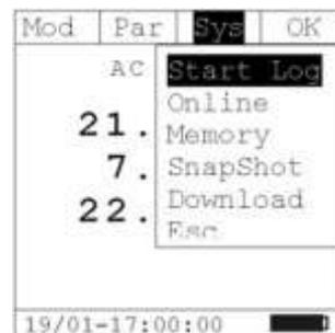
Электрические параметры сети можно записывать, передавать на ПК посредством Bluetooth или сохранять снимки дисплея, в соответствии с режимом работы:
