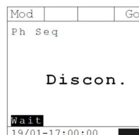
5. Прибор ожидает подключение ко второй последовательности фаз L1. Подключите щуп к фазе L1 второй последовательности.
