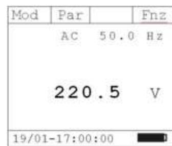
Меню «Fnz» в режиме измерения напряжения AC+DC (кнопка F4)
