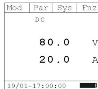
Меню "Fnz" в режиме измерения напряжения и тока (кнопка F4)
