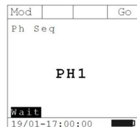
3. Если напряжение 100 В или выше обнаружено, прибор издает звуковой сигнал и на дисплее отображается сообщение " " - измерено. Не нажимайте никакие кнопки и держите щуп, подключенным к фазе L1.
