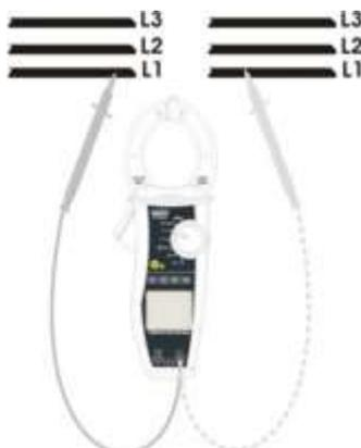
1. После выбора режима прибор ждет подключения фазы L1 и экран принимает вид, как показано на рисунке.
