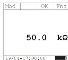
Вид экрана с примером измерения непрерывности цепи. Если измеренное сопротивление ниже, чем выбранное предельное значение (см. п. 5.2.5.), то будет непрерывно звучать зуммер.
