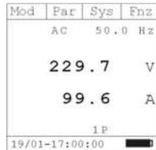
Меню "Fnz" (кнопка F4) режиме измерения напряжения и тока AC
