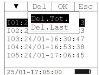
При нажатии кнопки F4 (Esc) отменяется процесс удаления. Повторное нажатие F4 (Esc) возвращает прибор к экрану измерения пускового тока.
