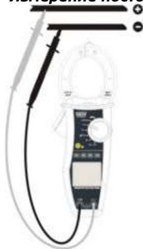
Подключите красный провод к разъему « $U\Omega$ » и черный провод к разъему «**ОБЩ.**» и подключитесь к желаемой точке измерения.
