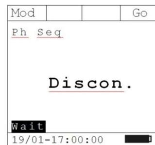
5. прибор ждет подключения фазы L2 и экран принимает вид, как показано на рисунке. Подключите щуп к фазе L2.
