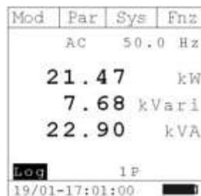
В режиме записи нажмите кнопку F3, чтобы открыть подменю «Sys». При каждом следующем нажатии на кнопку F3 курсор будет осуществлять прокрутку доступных элементов:
