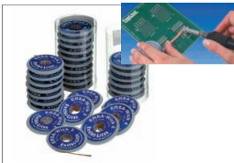
Впитывающая припой медная «косичка» WICK NC с **безотмывочным** флюсом на **антистатической** катушке. Используется для очистки контактных площадок от остатков припоя. Длина ленты 1,6 м, варианты ширины — 1,5 мм (для особо плотного монтажа SMT), 2,2 мм (универсальная), 2,7 мм (для очистки площадок под BGA). Цена 2,2 eur.
