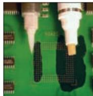
Инструмент в размере авторучки представляет собой резервуар емкостью 7 мл из упругого материала с эластичной кисточкой на конце. Многократно заправляется жидким флюсом любой разновидности: не требующим отмывки, водосмываемым, агрессивным с кислотной составляющей, а также отмывочными жидкостями на спиртовой основе для локальной обработки зон печатных плат. Наиболее популярной заправкой для BONPEN является ремонтный флюс IF8001, поставляемый в 100 мл флаконах фирмой ERSA.
