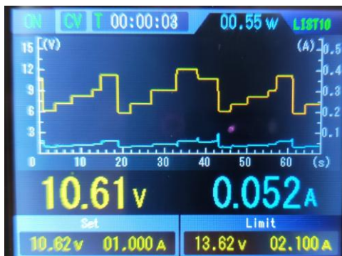
Выходной профиль U/I с индикацией текущей точки №10 в списке (List-10)
