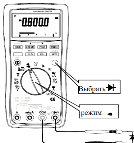
Рис. 18 Режим теста диодов (р-п). Для активации следует выбрать: \rightarrow \nabla .
