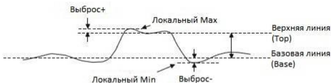
Рис. 16-2 Выбросы на импульсном сигнале
