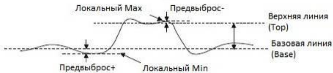
Рис. 16-3 Предвыбросы на импульсном сигнале
