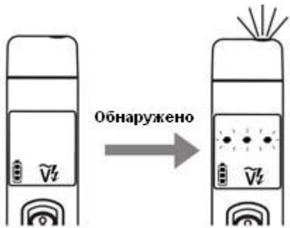
Детектирование напряжения можно осуществлять только на изолированных проводах. Тестируйте провода высокого напряжения на дистанции 20 мм, иначе это может быть опасным.
