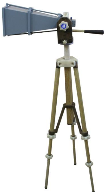
Фото 1. Рупорная антенна на диэлектрическом штативе
