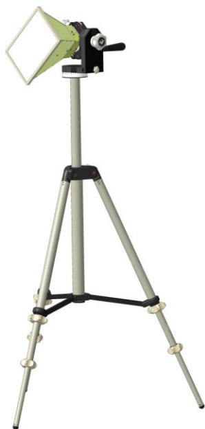
Рис. 1 3D модель рупорной антенны на диэлектрическом штативе
