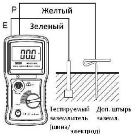
3. Ток в тестируемой цепи не превышает 2 мА, поэтому в случае использования УЗО в цепях заземления, прибор не вызывает ложного срабатывания устройств защиты. При проведении измерений по 3-х проводной схеме (режим ТОЧНО), свечение красного светодиода на панели прибора подтверждает поддержание номинального значения тестового тока.
