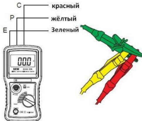
Замыкание наконечников «крокодил» изм. проводов для калибровки 0-показаний.
