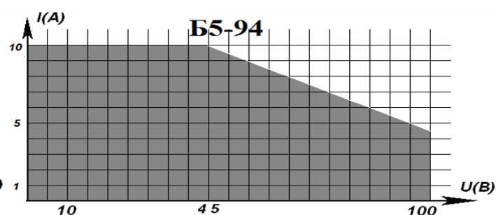
Источники сертифицированы с нормированием по 15-и основным параметрам, могут работать в режиме стабилизации напряжения и тока, допускают параллельное и последовательное соединение, обеспечивая долговременную работу на полной нагрузке (до 450 Вт).
