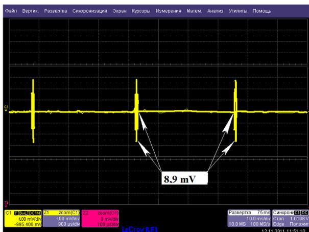
Источники питания имеют низкие пульсации выходного напряжения и тока. В самых трудных режимах на полной нагрузке амплитудное значение пульсаций напряжения не превышает 9,0-10,0 мВ, что не вносит помех в работу запитываемой радиоаппаратуры.
