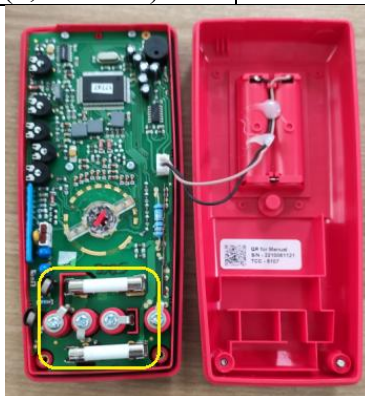
Прибор со снятой задней панелью (на рис. внизу в рамке - 2 предохранителя )
