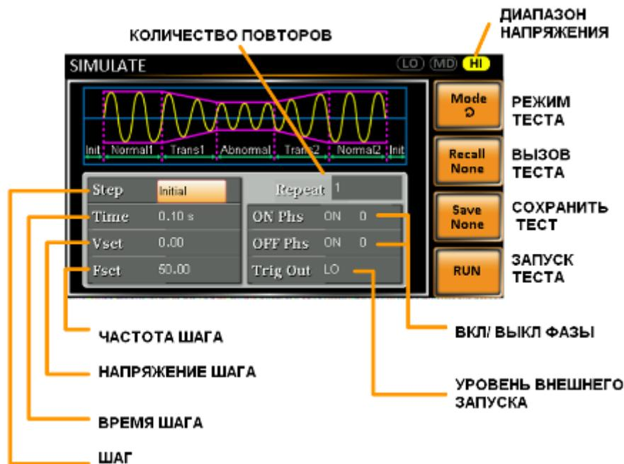
Функция моделирования состоит из 6 шагов. Каждый шаг выполняется последовательно в следующем порядке: Initial (инициализация), Normal1 (нормальный сигнал), Trans1 (переходный процесс), Abnormal (имитация аномалии или флуктуации), Trans2 (переходный процесс), Normal2 (нормальный сигнал), Initial (инициализация).
