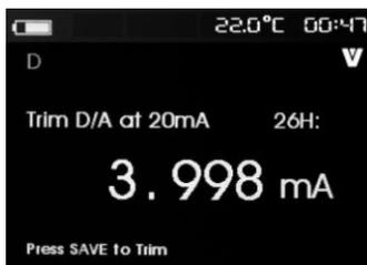
Когда выходное значение фиксировано на 20 мА, на экране появится измеренное калибратором значение. Значение будет меняться каждую секунду.
