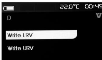
Если не запущен режим записи, то данная функция будет не доступна. Для выбора нужной функции используйте клавиши «▲»/«▼». Нажмите клавишу ENTER для запуска выбранной функции. Нажатие клавиши EXIT отключит режим HART.
