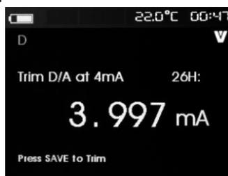
Когда выходное значение фиксировано на 4 мА, на экране появится измеренное калибратором значение. Значение будет меняться каждую секунду.
