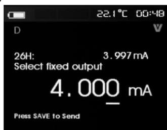
Режим используется для установки фиксированного выходного значения, на экране появится измеренное калибратором значение. Значение будет меняться каждую секунду. Диапазон установки 3.0 мА – 21.0 мА.
