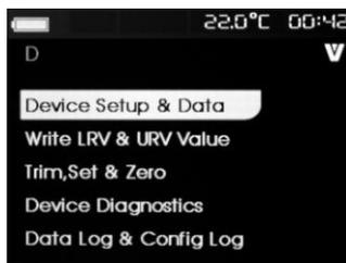
Символ **V** в правом верхнем углу экрана показывает активное соединение по протоколу HART в реальном времени. Для выбора нужной функции используйте клавиши «▲»/«▼». Нажмите клавишу ENTER для запуска выбранной функции. Нажатие клавиши EXIT отключит режим HART.
