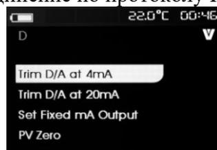
Если не запущен режим записи, то данная функция будет не доступна. Для выбора нужной функции используйте клавиши «▲»/«▼». Нажмите клавишу ENTER для запуска выбранной функции. Нажатие клавиши EXIT отключит режим HART.
