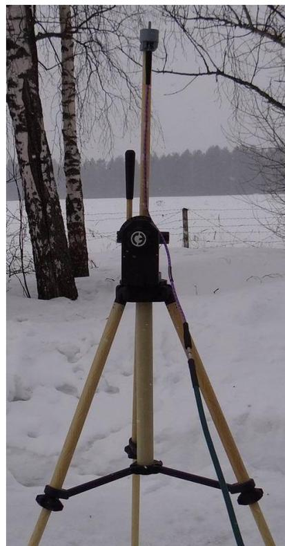
**Фото2.** Антенна АС7.24 на диэлектрическом штативе
