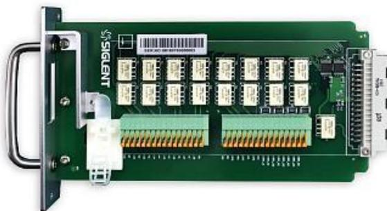
16-канальный сканер для вольтметров АКИП-2101 и АКИП-2101/2
