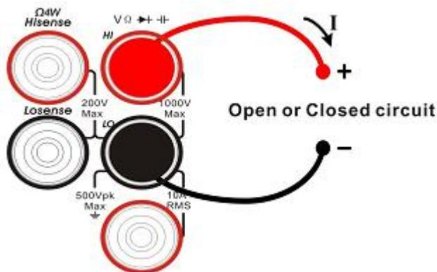
3. Установить сопротивление короткого замыкания. По умолчанию установлено значение 50 Ом. Нажать кнопку **【Threshold】**. Использовать кнопки со стрелками для установки требуемого значения сопротивления короткого замыкания. Выбрать необходимые настройки для проверки целостности цепи:
