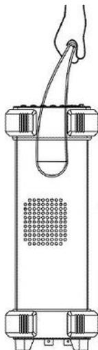
Для изменения положения ручки оттяните ее от прибора и поверните на нужный угол, зафиксируйте в одном из доступных положений (см. рис. ниже).
