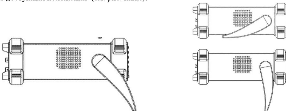
При необходимости установки прибора в стойку снимите ее. Для снятия ручки поверните ее вверх на 90° по отношению к корпусу прибора и оттяните ее так, чтобы фиксаторы вышли из пазов корпуса, снимите ручку. Установка производится в обратном порядке.
