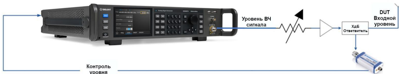
Рис 10-1 Схема подключения измерителя мощности к генератору для контроля выходного уровня
