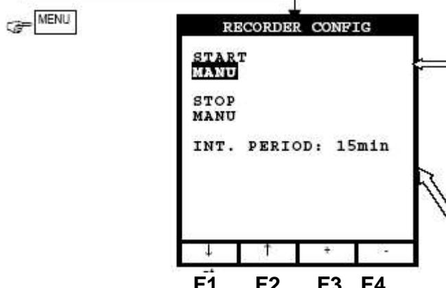
Выбирать **РУЧНОЙ** или **АВТОМАТИЧЕСКИЙ** способ начала/остановки регистрации: установить курсор на **MANU** или **АВТО** с помощью кнопок **F1** или **F2**; выбрать требуемый вариант кнопками **F3** или **F4**.
