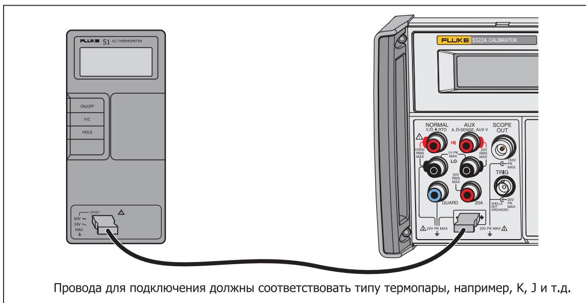
Рисунок 4-22. Подключения кабелей для тестирования термометра серии 50
