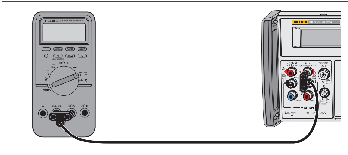
Рисунок 4-8. Подключение испытываемого устройства: Постоянный ток/Переменный ток
