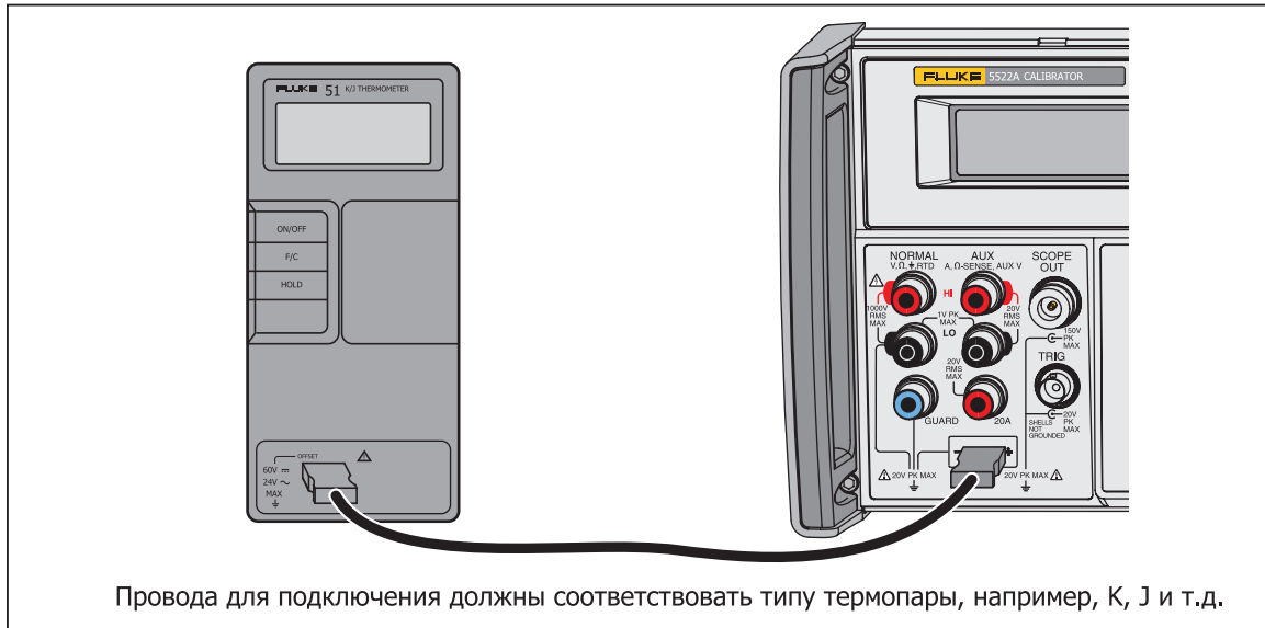
Рисунок 4-10. Подключение испытываемого устройства: Температура (Термопара)
